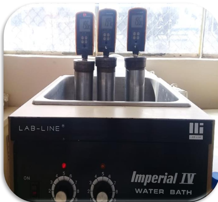
Imagen 10. Cilindros de acero (difusividad térmica)
