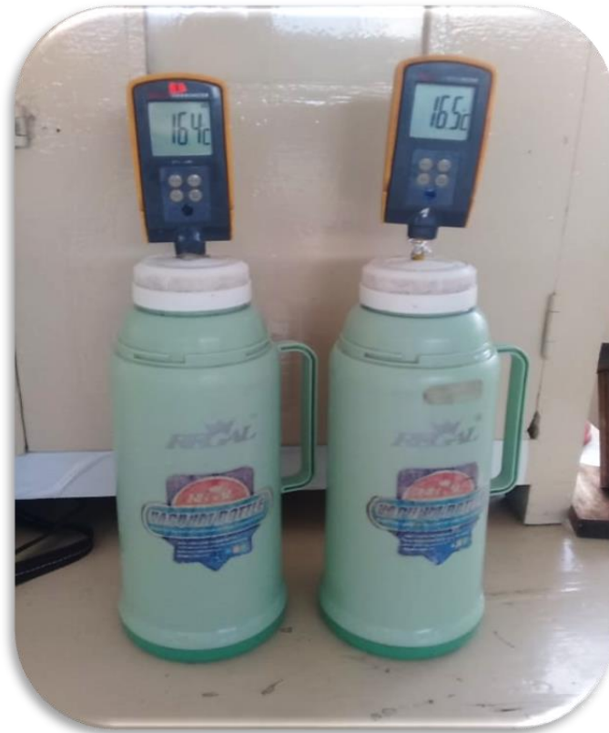
Imagen 9. Calorímetros (calor específico)
