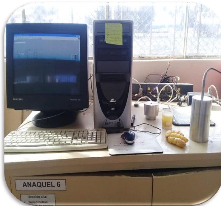
Imagen 11. Método de sonda (conductividad térmica)
