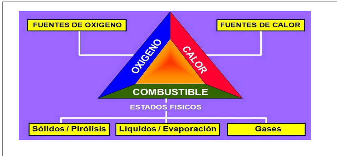
Figura 1. Triángulo de Fuego Fuente: Cabrera, 2016
