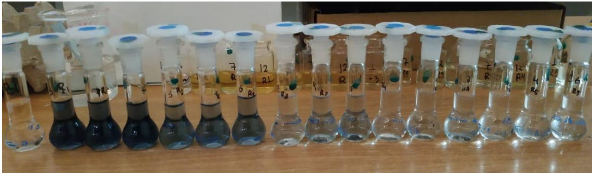
Figura 18. Desgaste del material vegetal, del extracto (a) y con las pruebas para flavonoides (b) y polifenoles (c)
