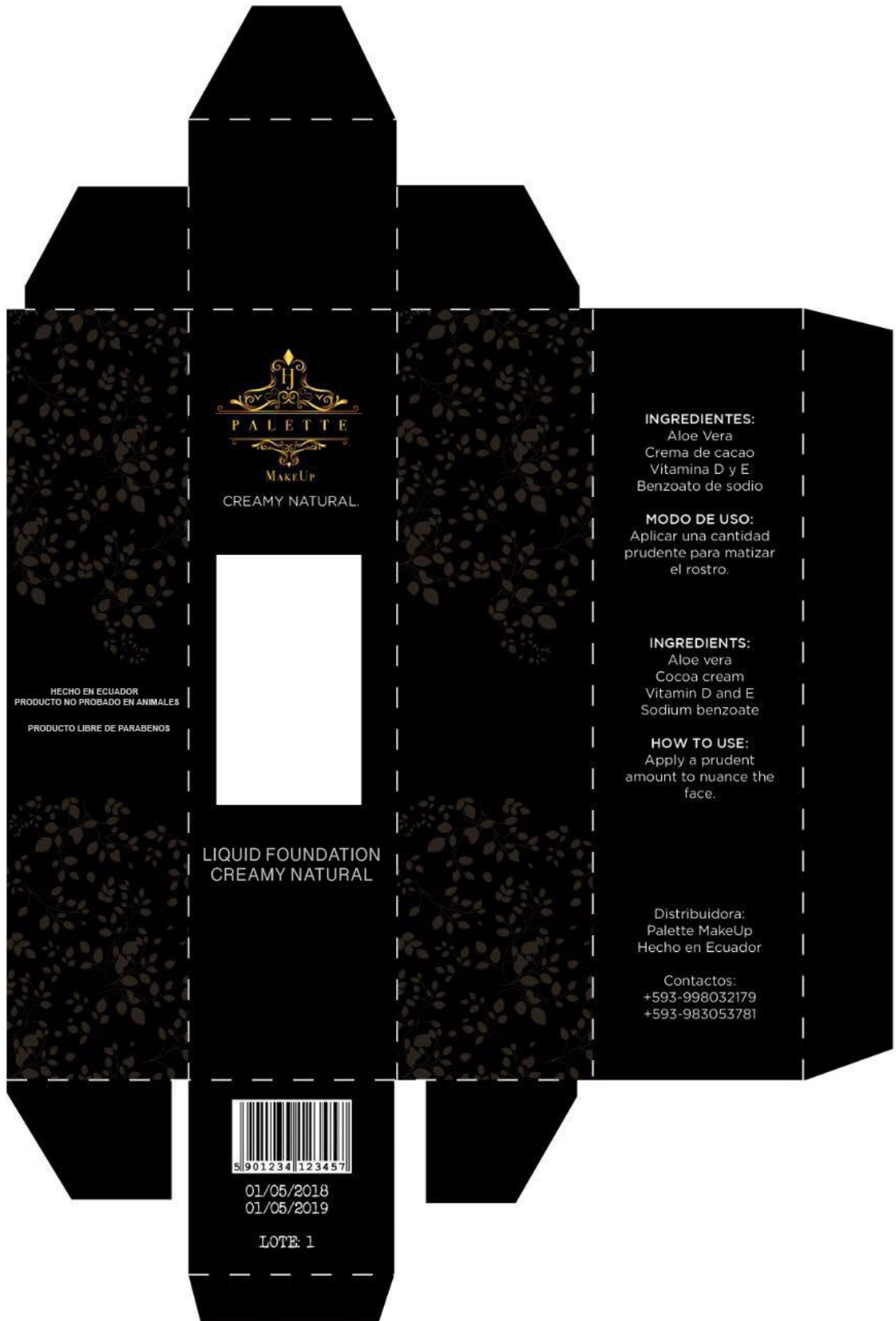
Figura 34. Troquelado de la caja para el producto
