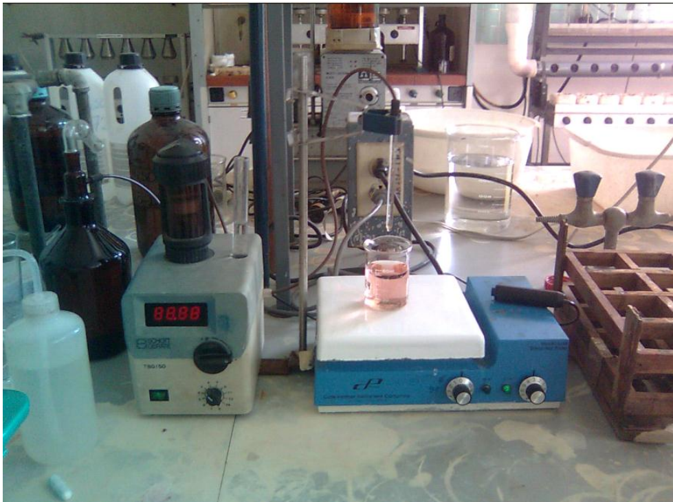
Fotografía 21. Titulación de las muestras con un cambio de coloración del turquesa a tomate
