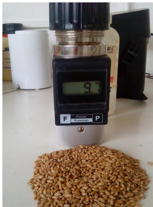
Fotografía 35. Medida de la humedad del grano de cebada
