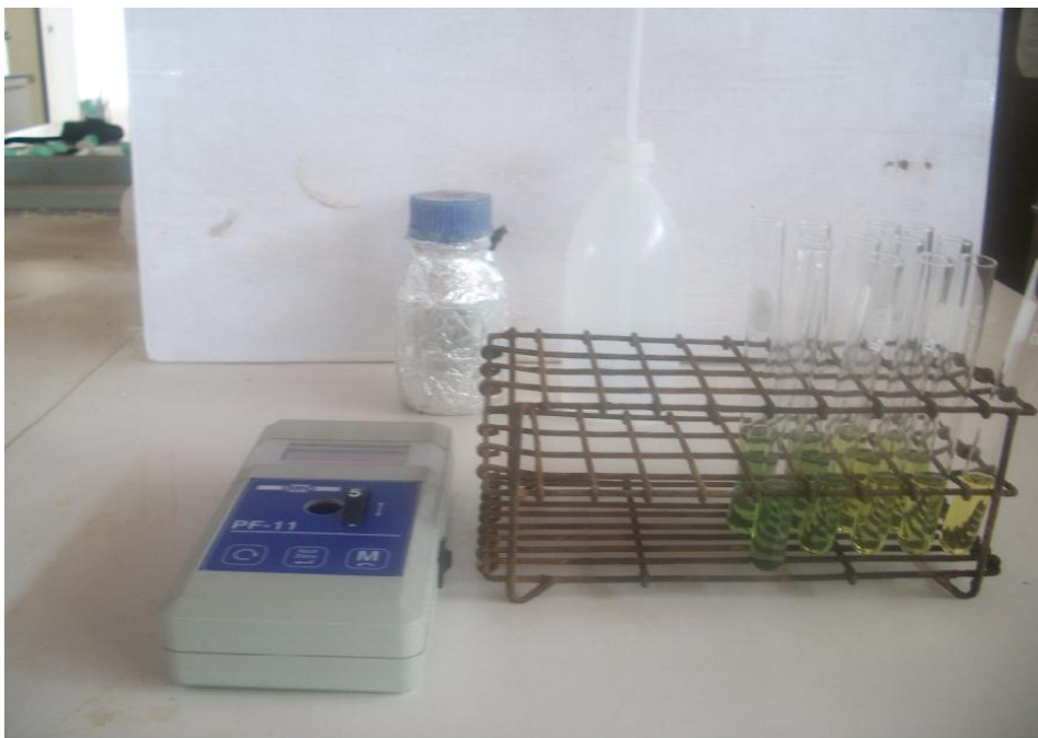
Fotografía 6. Lectura de la absorbancia por medio de un espectrofotómetro
