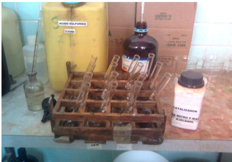
Fotografía 16. Adición de la mezcla catalizadora en las muestras
