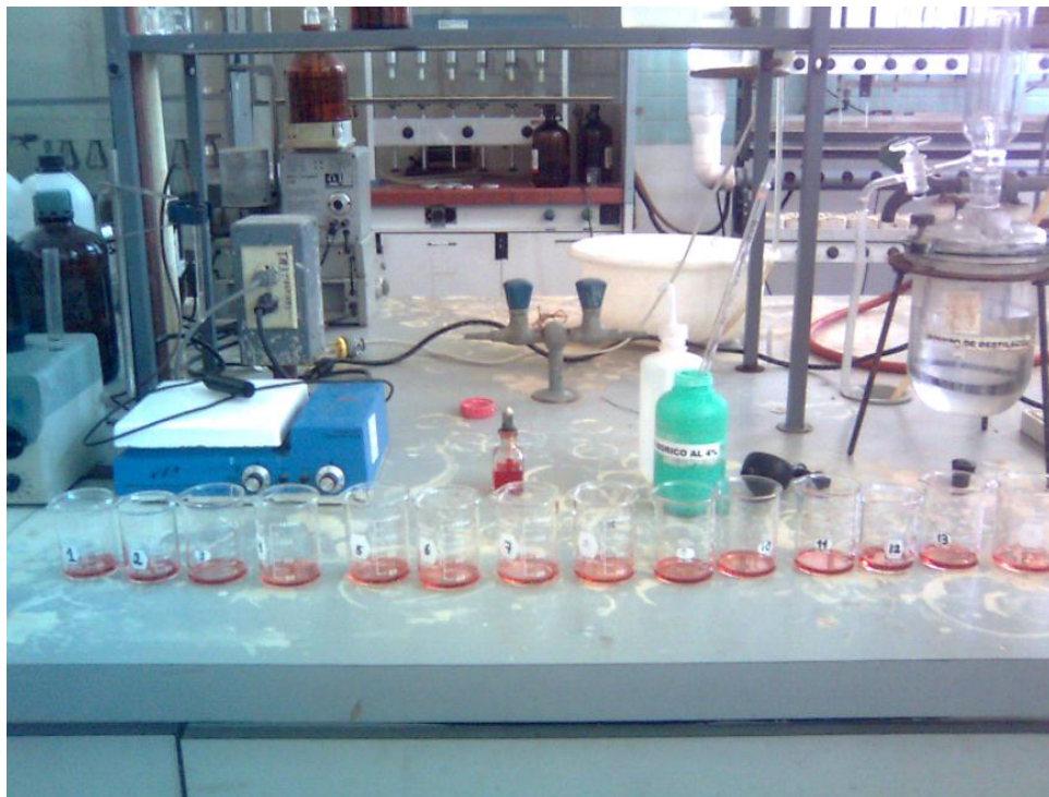
Fotografía 18. Vasos de precipitación con ácido bórico e indicador mixto
