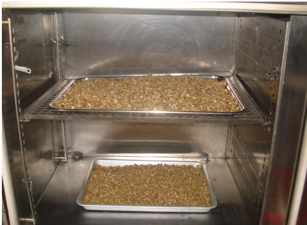
Fotografía 25. Secado de las muestra en la estufa de aire forzado
