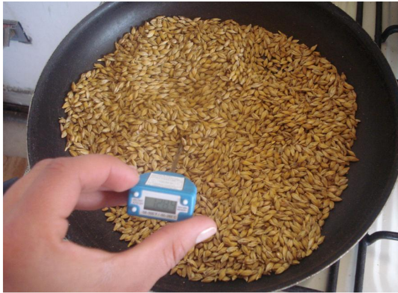
Fotografía 32. Termómetro para el control de temperatura en el tostado de las muestras de cebada
