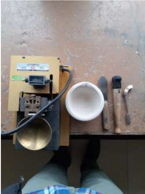
Materiales y Equipos para el ensayo de Límite Líquido
