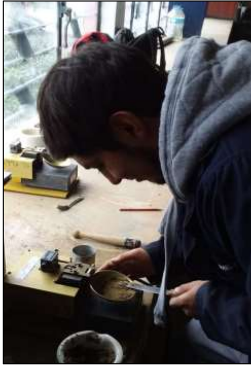
Figura 24 Ensayo Límite Líquido (Copa Casagrande)
