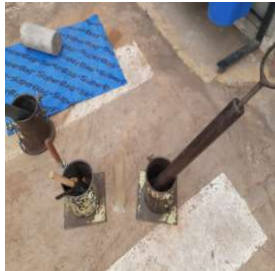
Recipientes metálicos, probeta, martillo de compactación para realizar el ensayo Próctor.
