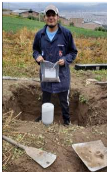
Figura 21 Ensayo Densidad de Campo (Método del Cono y Arena de Ottawa) Autor: Cristhian Andrés Bonilla Espinosa
