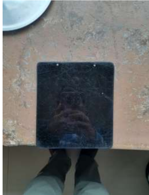
Placa de vidrio para el ensayo de Límite Plástico
