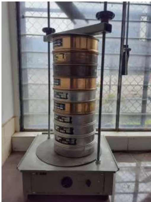
Tamizado de muestras para el ensayo de Granulometría
