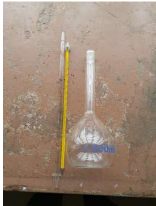
Termómetro, pipeta y picnómetro para realizar el ensayo de Gravedad Específica
