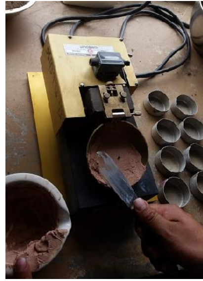
Colocación de la muestra de suelo en la copa de Casagrande
