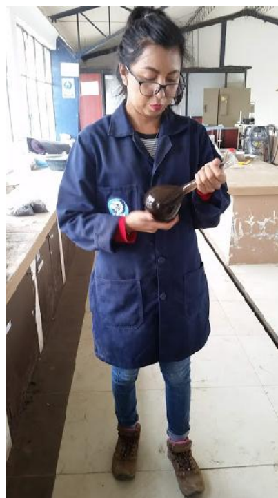
Rotación del picnómetro hasta que salgan todas sus burbujas
