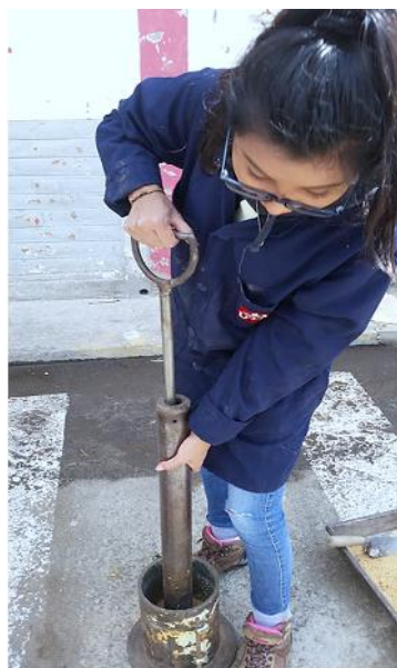
Compactación del suelo por capas con el martillo
