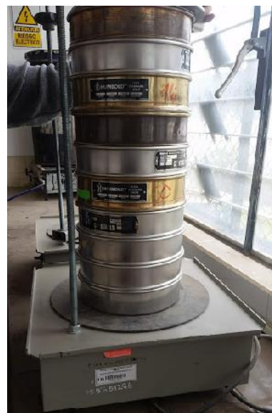
Tamices colocados en la tamizadora con la muestra a ensayar
