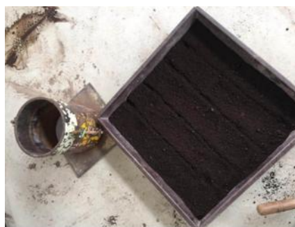
División del suelo para colocarlo en capas
