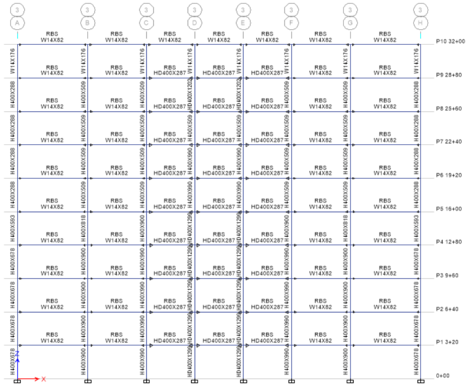
Figura 64: Vista en elevación del eje 3 de SMF.
