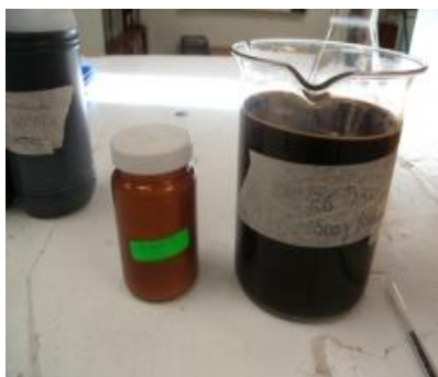
Muestras de melaza diluida y neutralizadas Carbonato de calcio y pHmetro digital
