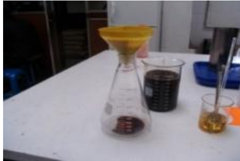
Figura 8. Filtración de la dilución de melaza
