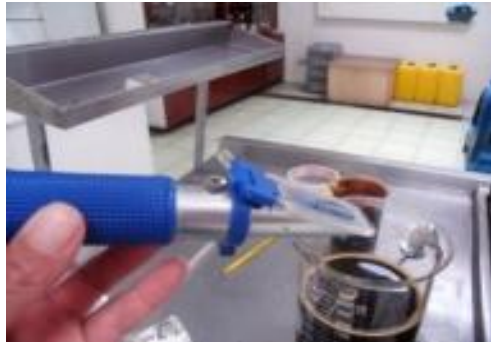
Figura 18. Determinación de sólidos solubles.
