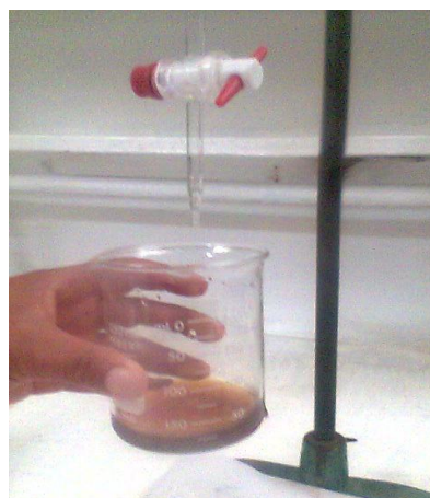
Figura 20. Determinación de la acidez de la melaza
