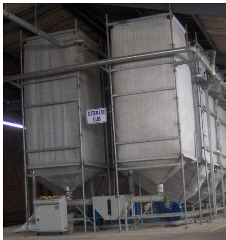
Gráfico N° 12: Maduración del Poliestireno en Silos Fuente: www.hormi2.com
