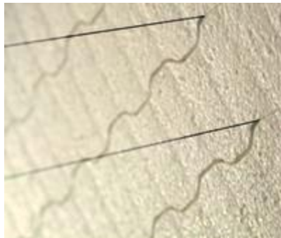
Gráfico N° 14: Corte del bloque de poliestireno Fuente: www.hormi2.com
