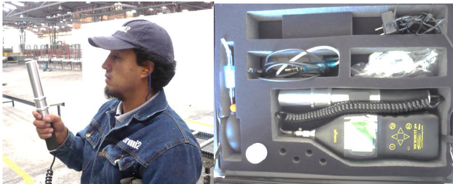
Gráfico N°38: Medición de la concentración de material particulado con el equipo específico. Realizado por: Investigador
