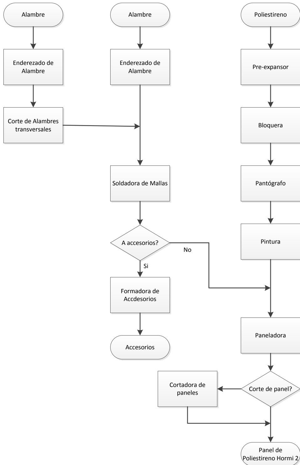
Gráfico N° 10: Proceso de Fabricación de Paneles Modulares Hormi 2 Elaborado por: Investigador
