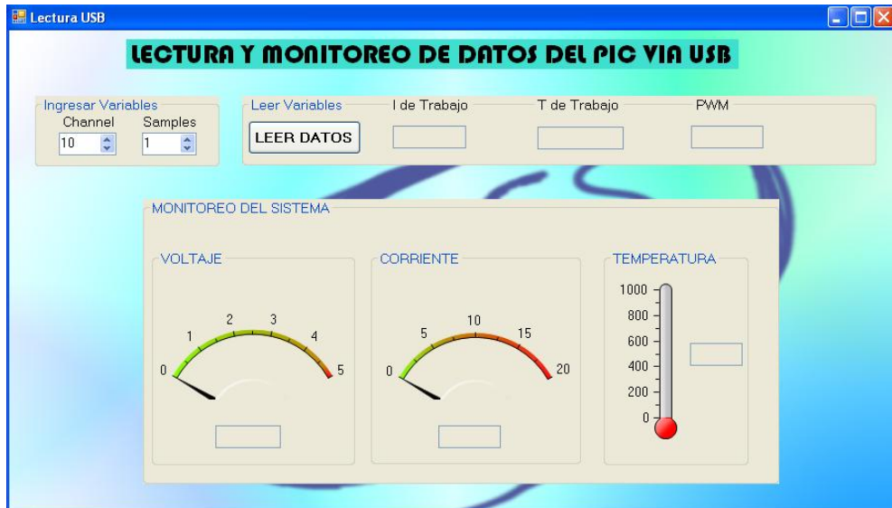
Figura 6. 47. Ventana de Lectura y monitoreo del PIC
