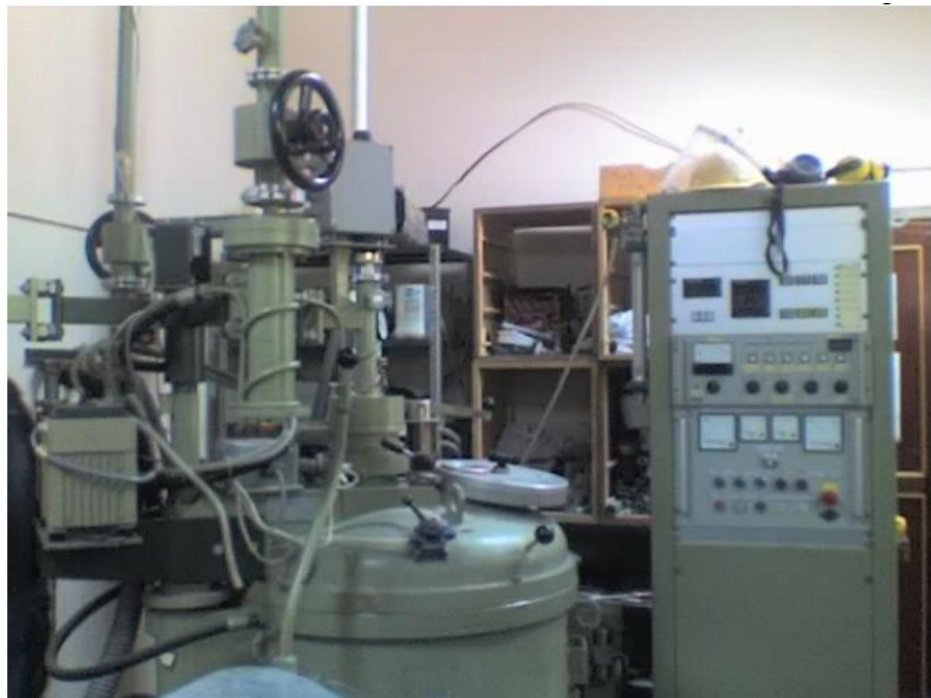
Figura 2. 5. Horno de Arco Eléctrico
