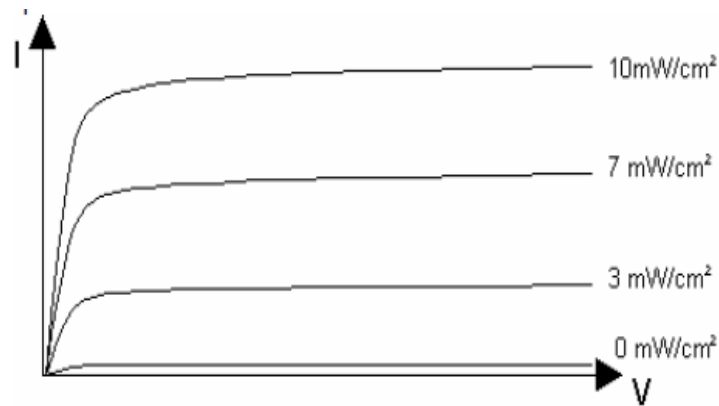
Figura 2. 29. Curvas de funcionamiento del fototransistor
