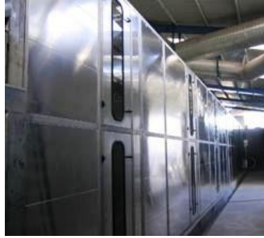
Grafico 2: Túnel de secado de Imtech DryGenic
