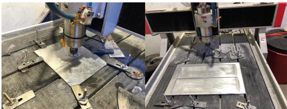
Fig. 32. Mecanizado de moldes en torno CNC
