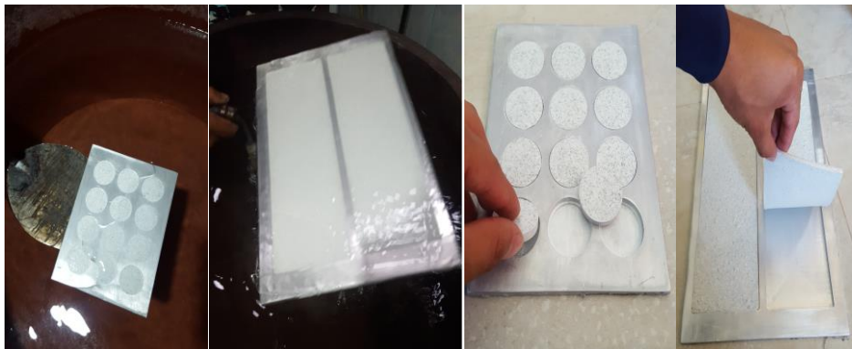
Fig. 42. Enfriamiento y extracción de probetas
