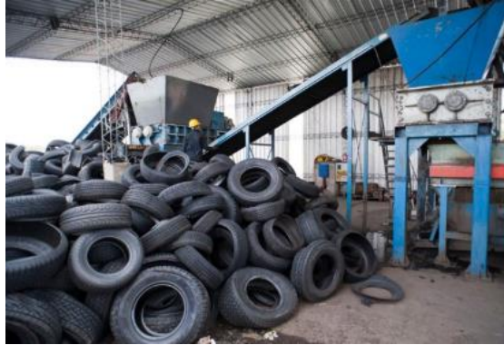
Fig. 19. Trituración mecánica de neumáticos
