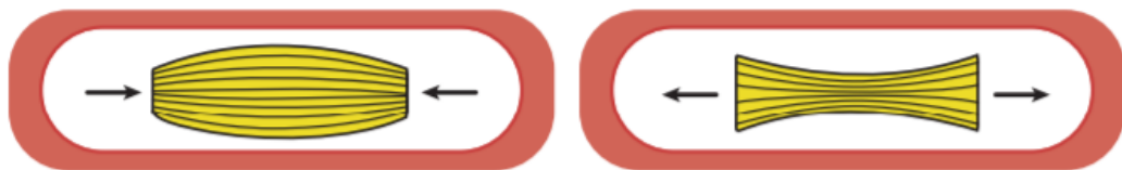
Fig. 4. Matriz bajo efecto de carga a compresión y tracción
