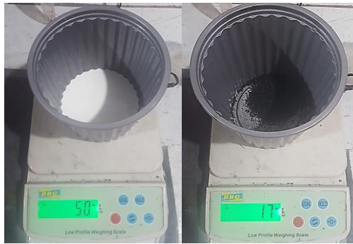
Fig. 36. Pesaje del látex sintético y gránulo de caucho
