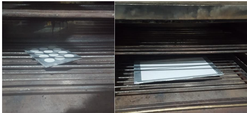
Fig. 41. Vulcanización del material compuesto
