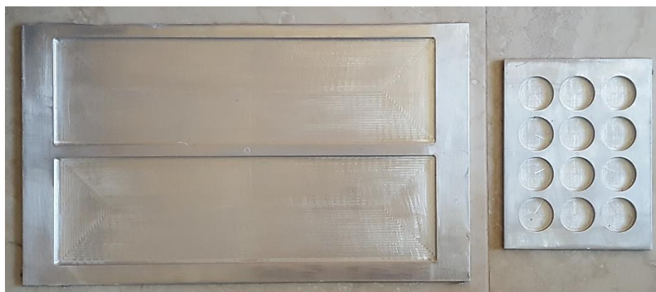
Fig. 33. Moldes terminados para ensayos de fricción e inflamabilidad
