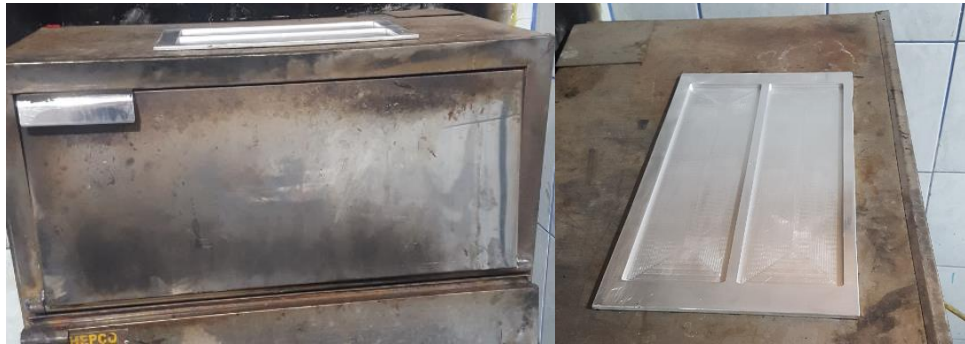
Fig. 38. Precalentamiento de moldes
