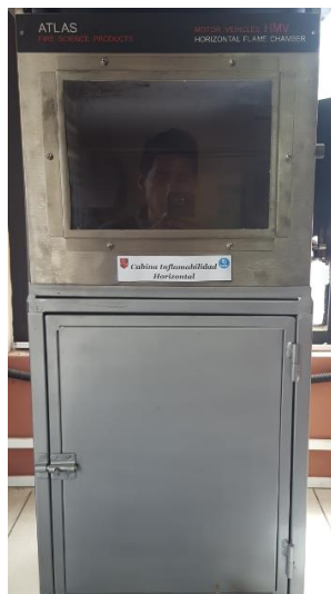
Fig. 17. Equipo para ensayo de inflamabilidad
