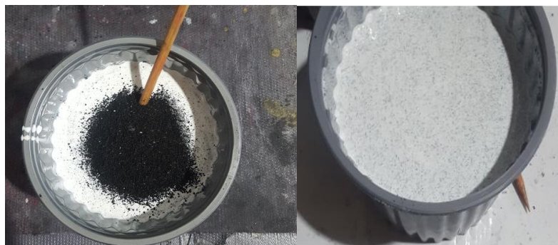
Fig. 37. Mezcla del látex sintético y gránulo de caucho
