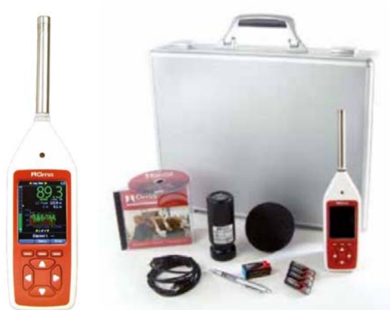
Figura 2 Sonómetro Cirrus Optimus Red
