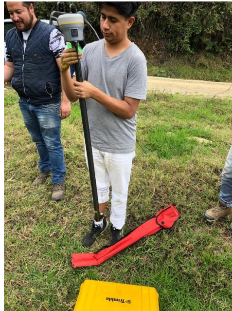
Anexo 12B. Armado del equipo móvil (RTK)
