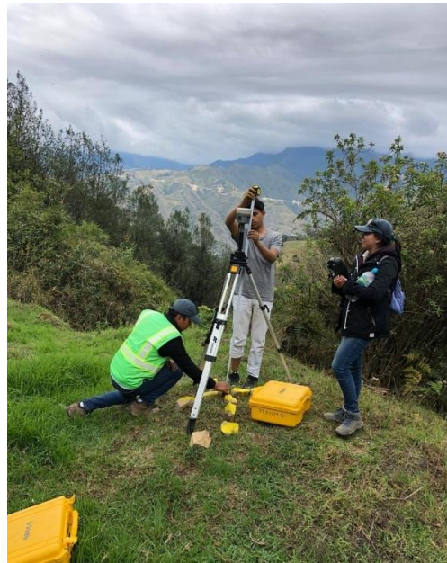
Anexo 10B. Medición de la altura del mojón hasta la base
