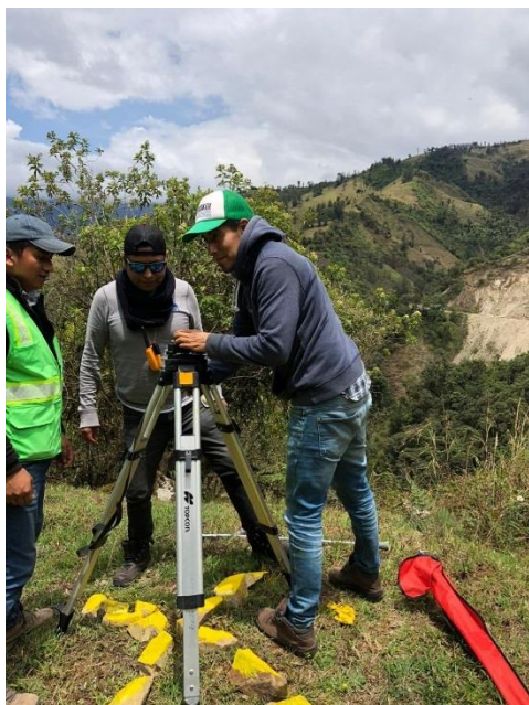
Anexo 7B. Colocación del trípode en el punto de referencia y nivelación
