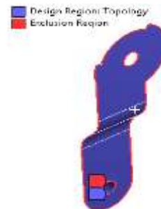
Figura 4.29 a) Región azul área del soporte de la codera a optimizar b) Contorno roja área del soporte de la codera que debe mantenerse con material
