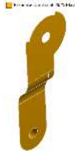
Figura 4.30 Área del soporte de la codera que se mantendrá con el 40% de material
