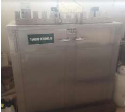
Figura No. 13 Tanque de Remojo Breber-Colman
