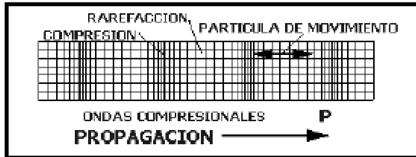
Figura 6. Propagación de las ondas “P” (Primarias)
