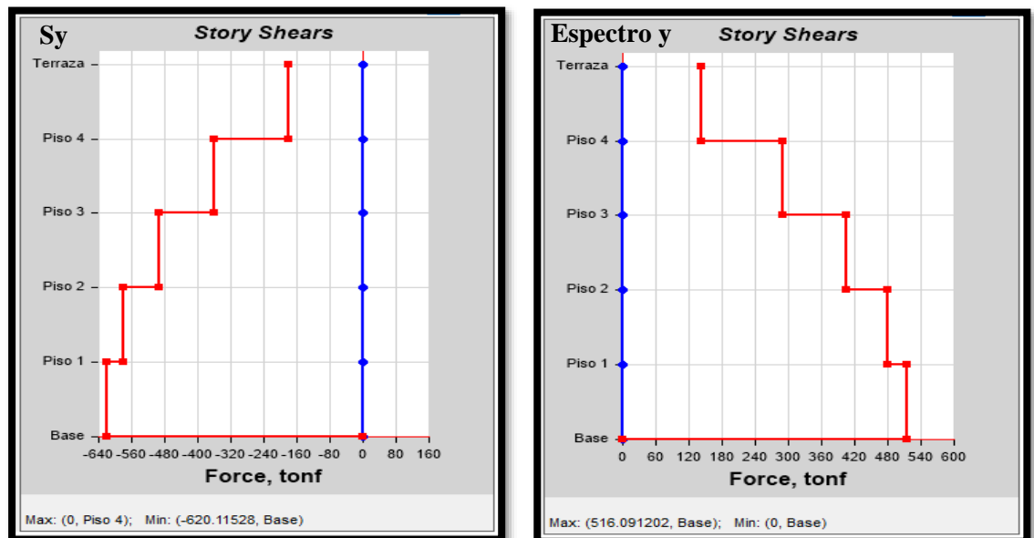
Figura 73. Cortante basal estático vs cortante basal dinámico en el sentido Y del suelo E
