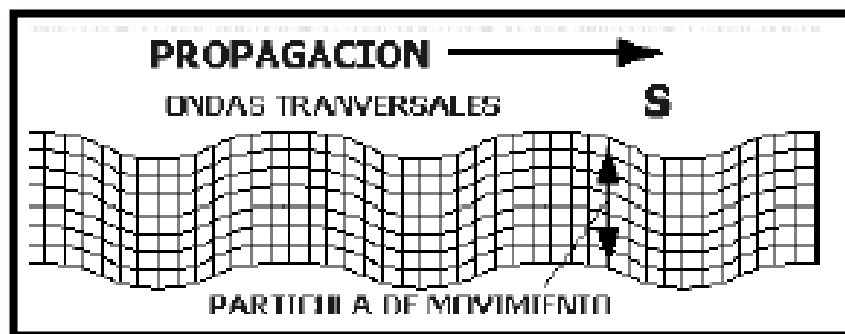
Figura 7. Propagación de las ondas “S” (Secundarias)
