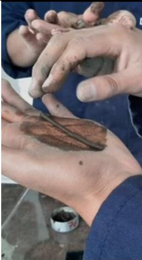
Descripción: Determinación del límite plástico de una muestra.
