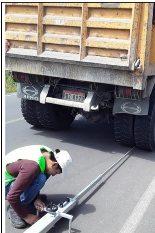
Descripción: Nivelación de la viga Benkelman previo a la medición de las deflexiones
