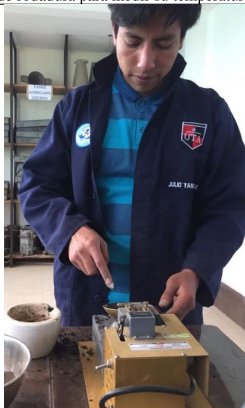
Descripción: Determinación del límite líquido utilizando la Copa de Casagrande.
