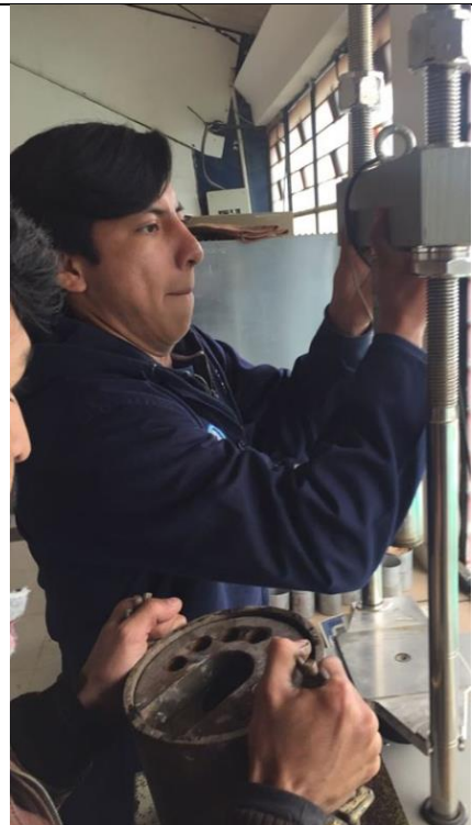
Descripción: Colocación del espécimen en la máquina para encontrar el valor de CBR.
