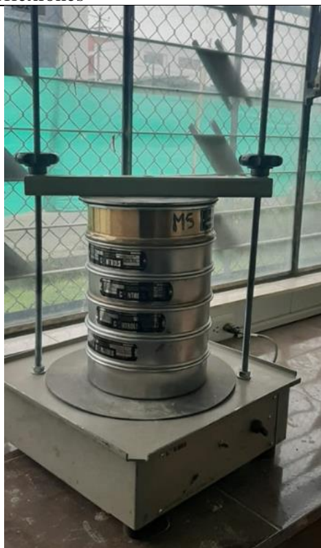
Descripción: Análisis granulométrico de la muestra de suelo.
