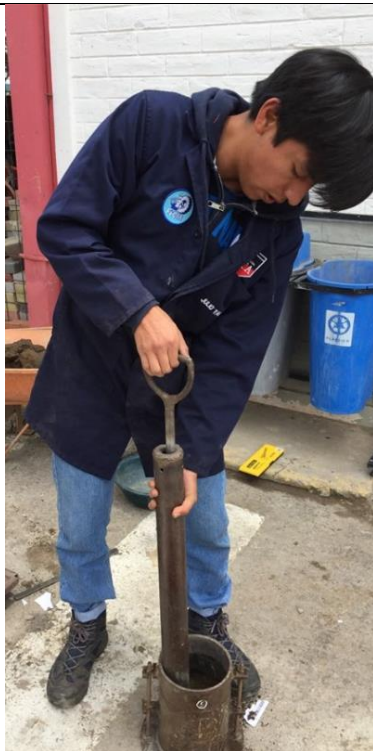
Descripción: Compactación del suelo previo al ensayo del CBR.
