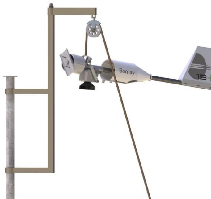
Imagen 8. Montaje del aerogenerador
