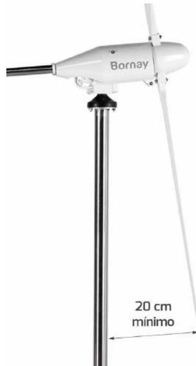
Imagen 7. Distancia mínima de las hélices y obstáculos
