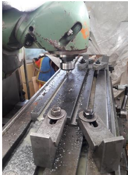
Figura 2.17. Fresado de ranuras en la base
