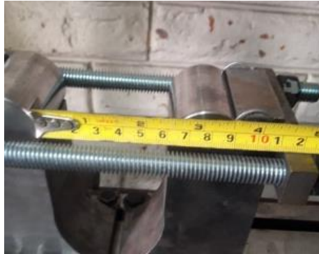
Figura 3.2. medida de 63.2 mm para realizar el ensayo de doblado guiado de espesor 3 mm según norma AWS B4.0
