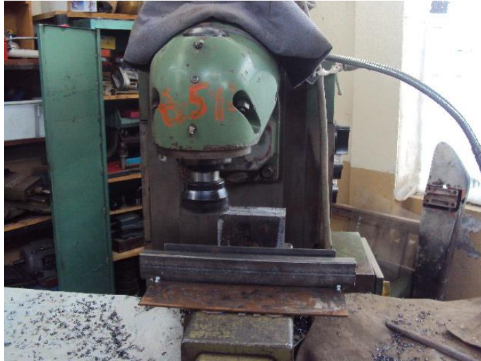
Figura 2.25. Desbaste de irregularidades del embolo 1.06''
