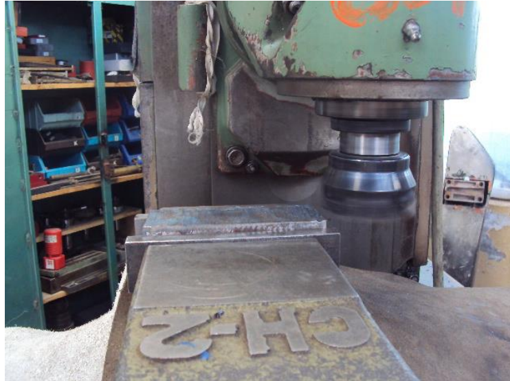
Figura 2.24. Desbaste de irregularidades del embolo 29/32
