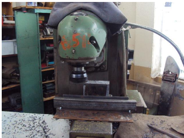
Figura 2.20. Desbaste de irregularidades del cuerpo del apoyo
