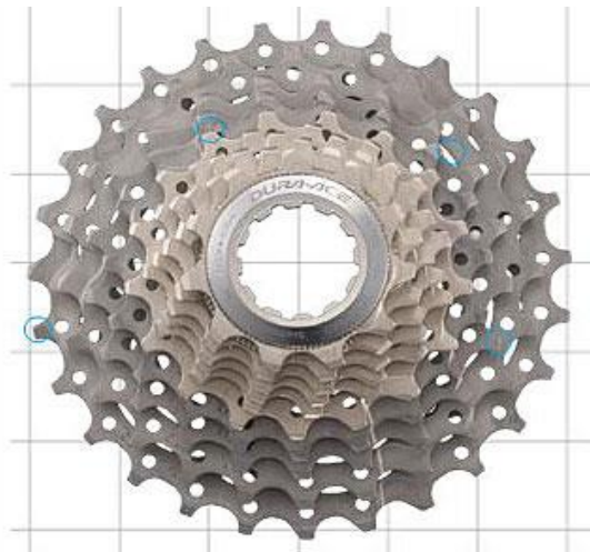
Figura 1.7. Aplicación de mecanismo de rueda libre [5]
