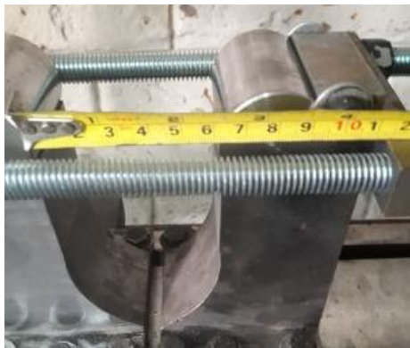
Figura 3.3. medida de 61.2 mm para realizar el ensayo de doblado guiado de espesores 6.35 mm y 9.53 mm según norma AWS B4.0
