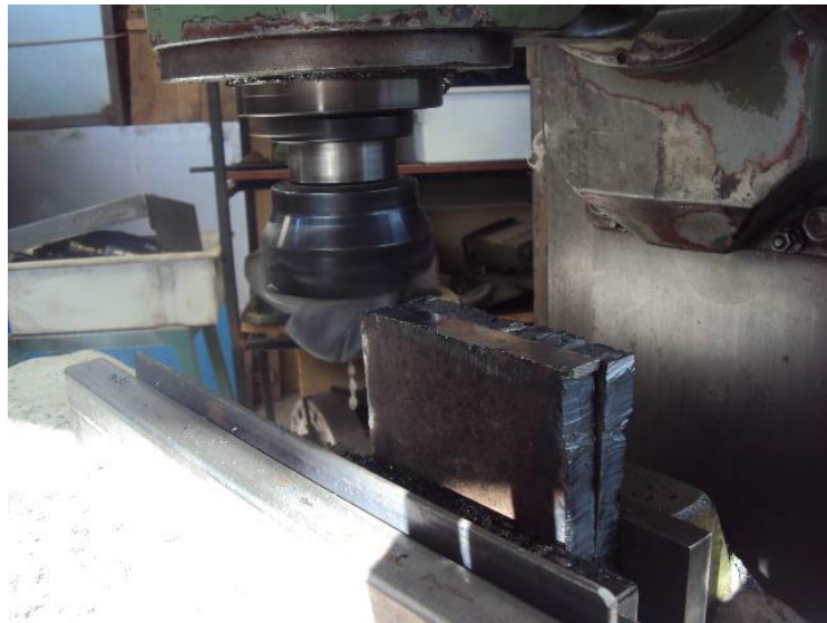
Figura 2.19. Desbaste de irregularidades de la base del apoyo
