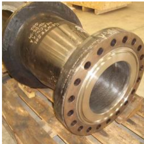
Figura 1.20. Ejemplo de soldadura de superficie [14]
