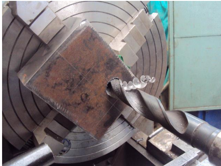
Figura 2.21. Perforado del cuerpo del apoyo
