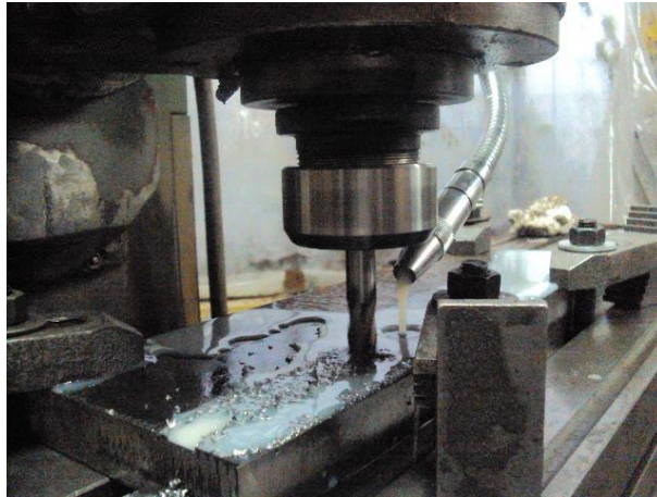
Figura 2.16. Fresado vertical en la base
