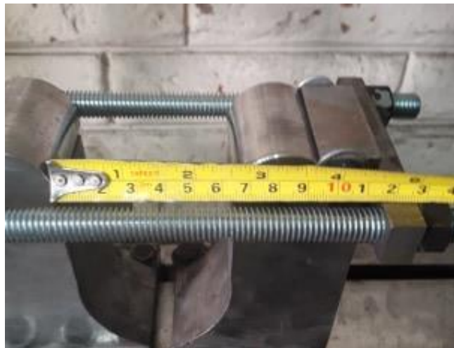
Figura 3.1. Medida de 60.36 mm para realizar el ensayo de doblado guiado según norma ASTM E190
