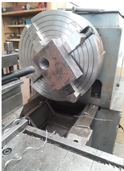
Figura 2.22. Torneado cilíndrico interior del cuerpo del apoyo
