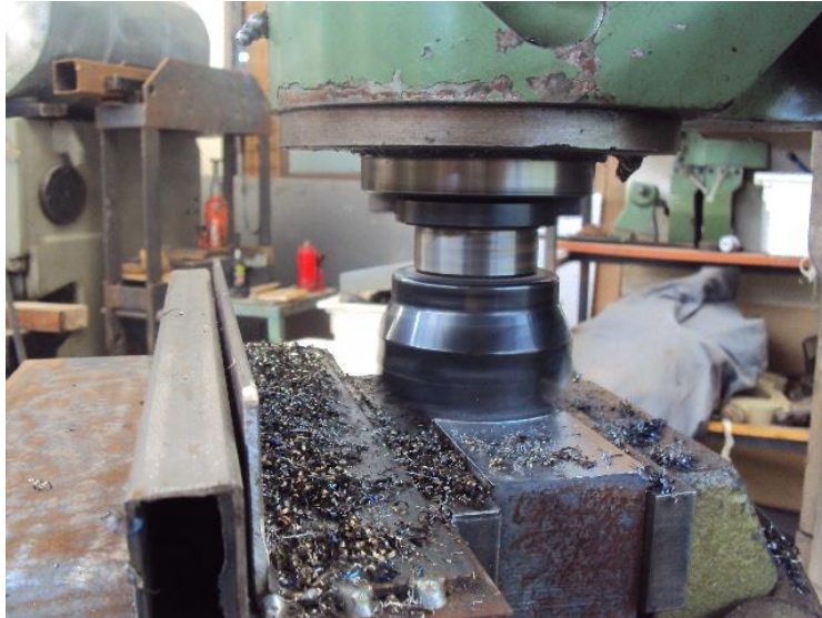
Figura 2.23. Desbaste de irregularidades del embolo \frac{3}{4}
