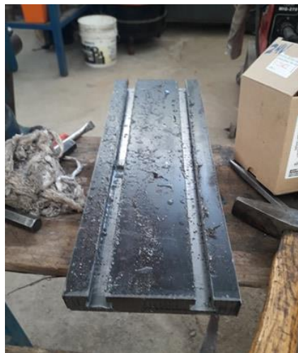
Figura 2.17. Fresado de ranuras en la base
