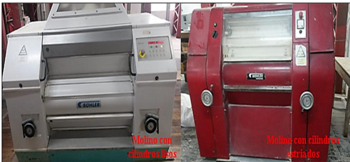
Fig 17. Molino con cilindros estriados y cilindros lisos.
