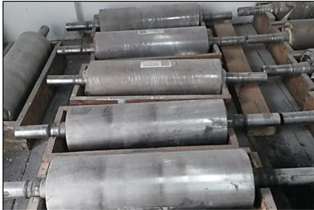
Fig 18. Cilindros metálicos para máquinas molineras.
