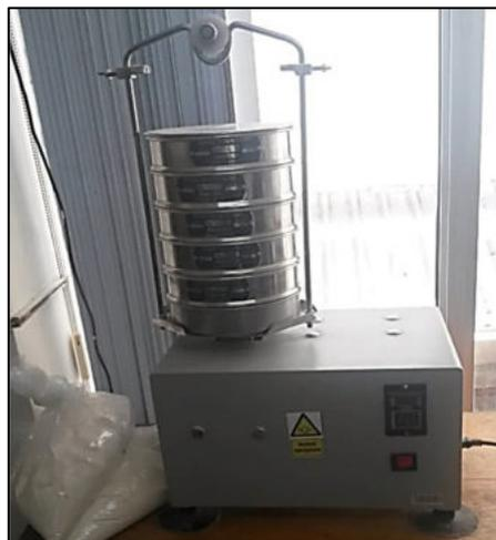
Fig 83. Equipo tamizador de laboratorio.
