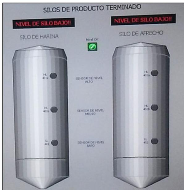
Fig 21. Visualización HMI de silos de almacenamiento de producto terminado.
