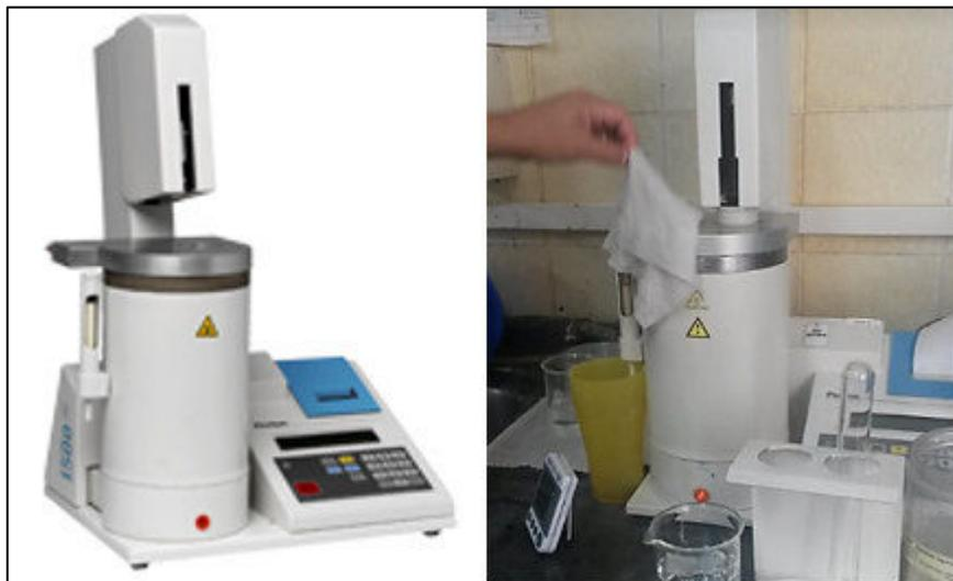
Fig 82. Equipo FN 1500 Falling Number.
