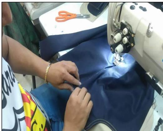
**Figura 18:** Unión de partes del pantalón
