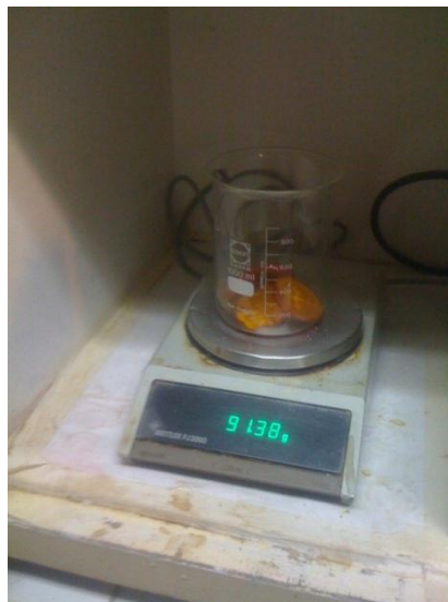
Gráfico D.36 Pesaje de las rodajas de tomate de árbol cada hora durante el proceso de Deshidratación Osmótica del Tomate de Árbol.
