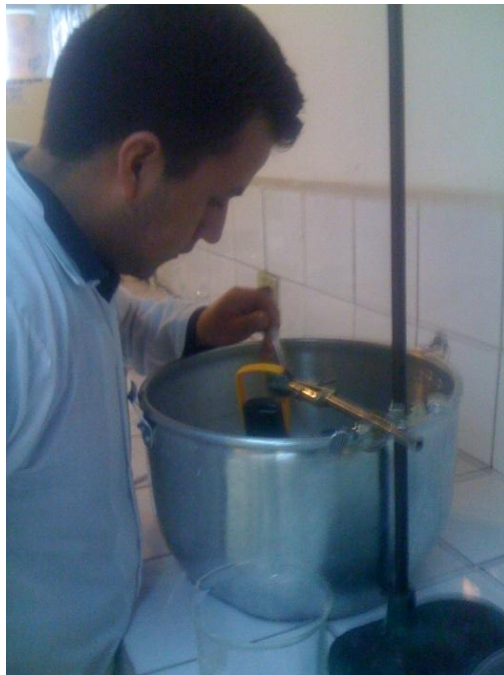
Gráfico D.34 Medición del °Brix del Jarabe con el Brixómetro durante el proceso de Deshidratación Osmótica del Tomate de Árbol.
