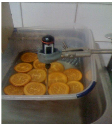
Gráfico D.32 Termocupla empleada en el control de la temperatura de la Solución durante el proceso de Deshidratación Osmótica del Tomate de Árbol.
