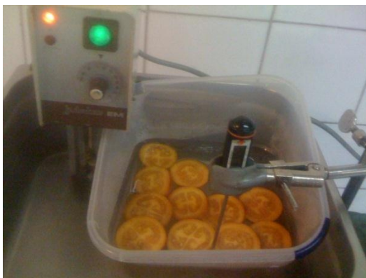
Gráfico D.32 Termocupla empleada en el control de la temperatura de la Solución durante el proceso de Deshidratación Osmótica del Tomate de Árbol.
