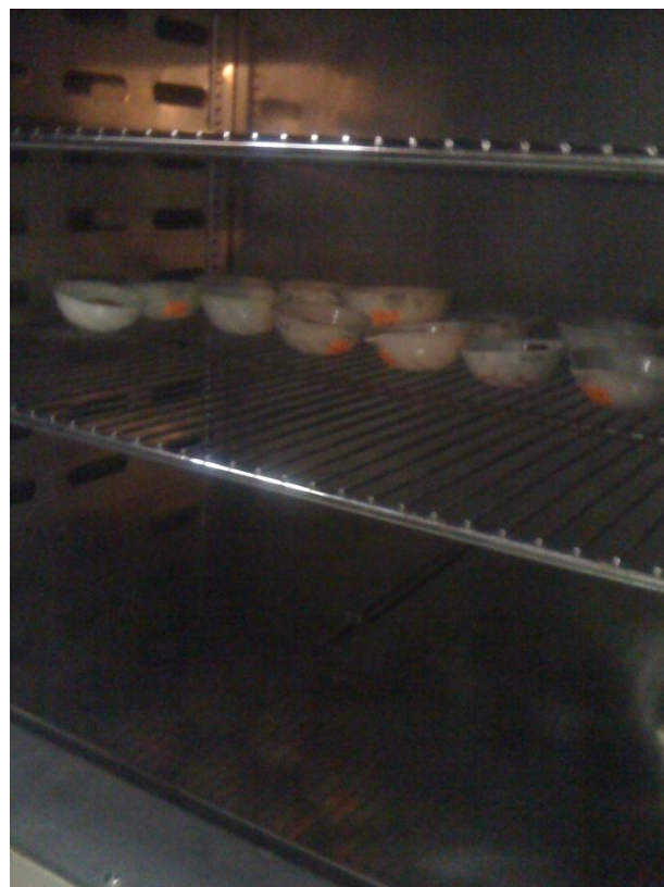
Gráfico D.38 Cápsulas en la estufa para la determinación de humedad
