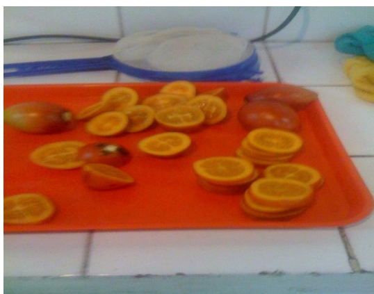
Gráfico D.26 Separación de las Rodajas para la determinación de humedad y pérdida de peso previa al proceso de Deshidratación Osmótica.
