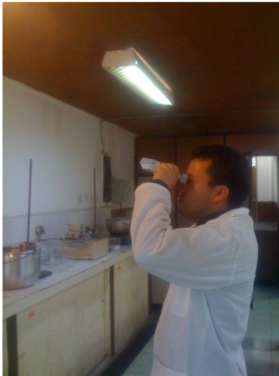
Gráfico D.34 Medición del °Brix del Jarabe con el Brixómetro durante el proceso de Deshidratación Osmótica del Tomate de Árbol.
