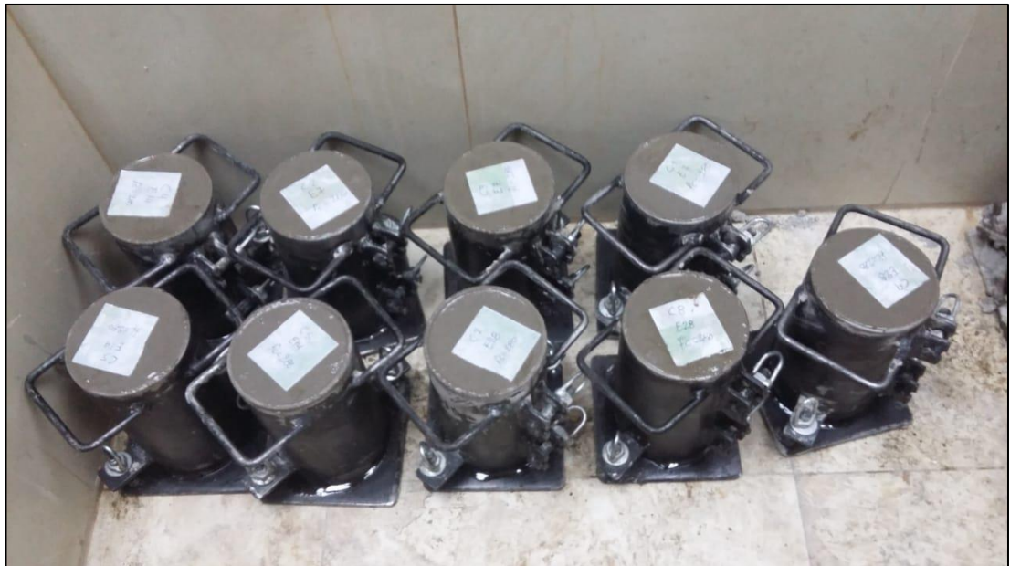
Figura 11. Almacenamiento en la cámara de curado Fuente: Nelson Chugchilan
