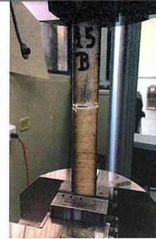
Fotografía No. 3: Probeta ensayada a tracción
