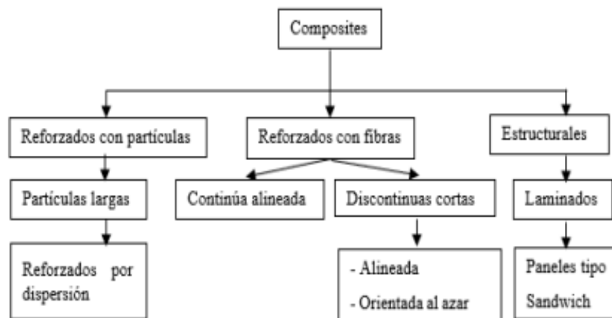
Figura 1.2 Clasificación de los materiales compuestos en función de su refuerzo.
