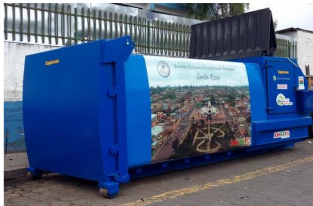
**Figura 4:** Caja compactadora de residuos sólidos
