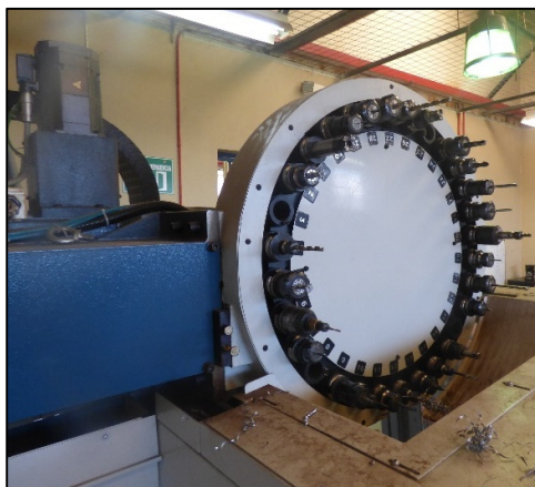
Figura N° 48: Herramientas del centro de mecanizado CNC
