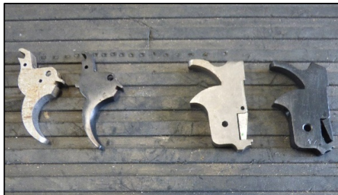
Figura N° 55: Pieza en crudo vs piezas pavonadas
