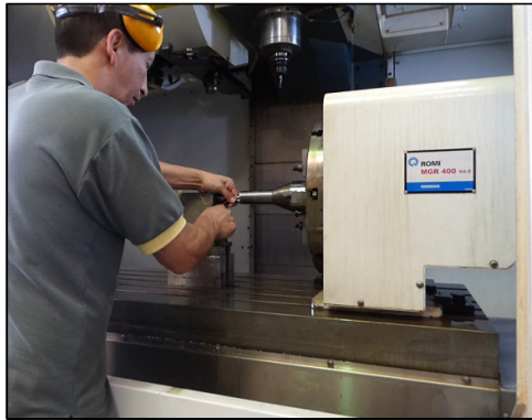
Figura N° 47: Centro de mecanizado CNC
