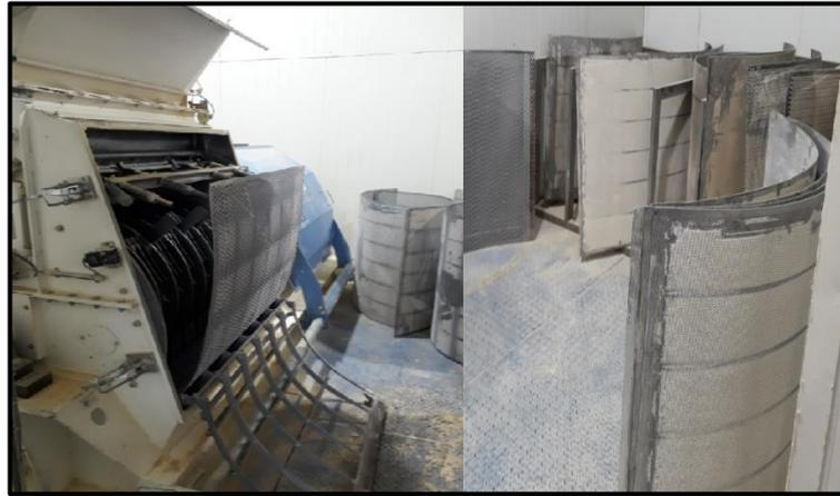
**Figura 12:** Molino de martillos y cribas
