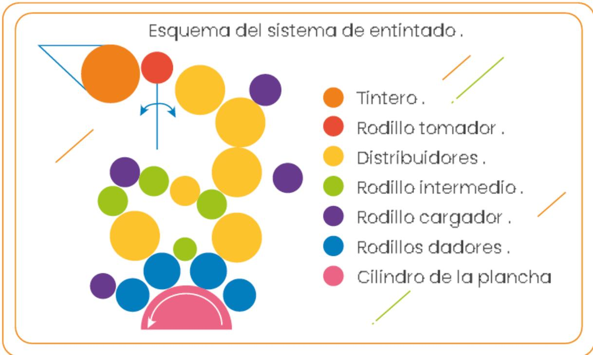
**Figura 12.** Esquema de sistema entintado
