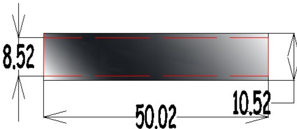
Riel Hueco: Vista Superior y Diámetro externo e interno
