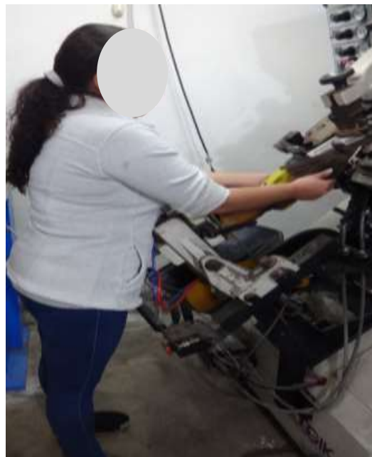
Control en la fuente para armado de talón y punta
