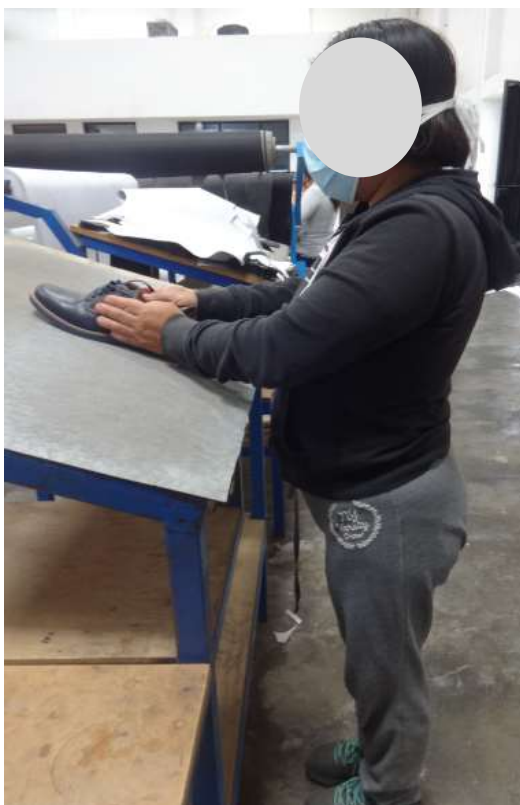
Control en la fuente para pegado de planta y capellada
