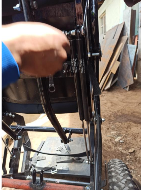
Figura 54: Ajuste de amortiguadores hidráulicos.
