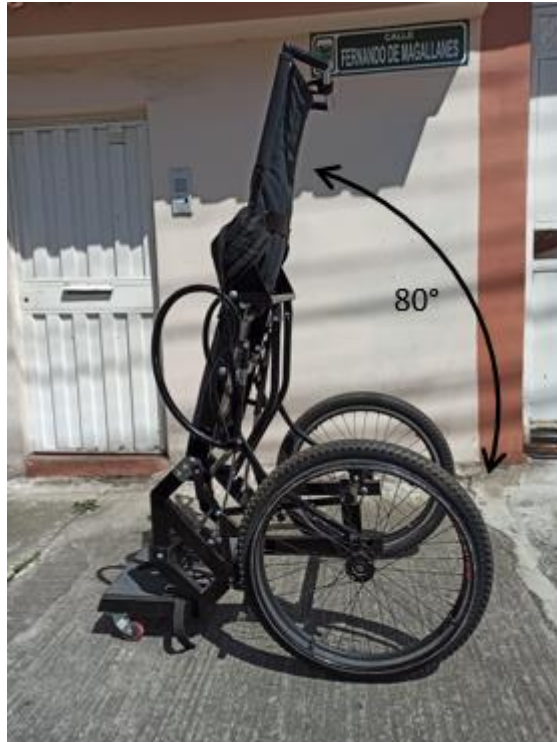
Figura 32: Angulo de inclinación, parte lateral del bipidestador.
