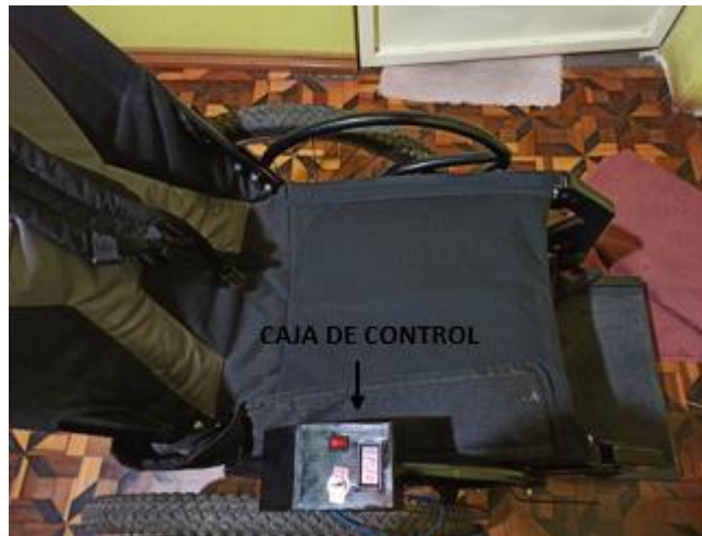
Figura 41: Colocacion del circuito de control.
