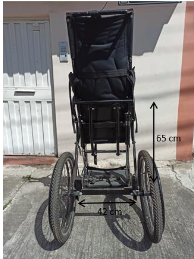
Figura 31: medidas del espacio disponible, parte trasera de la silla.
