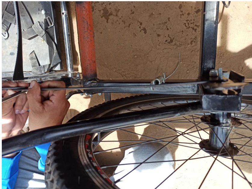
Figura 53: Separación del seguro manual.
