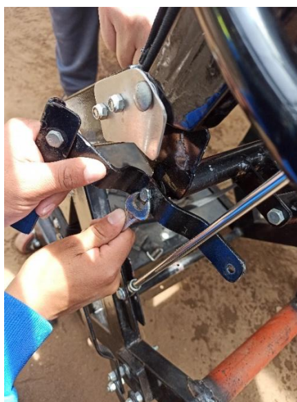
Figura 34: Desmantelación del seguro manual de la silla.
