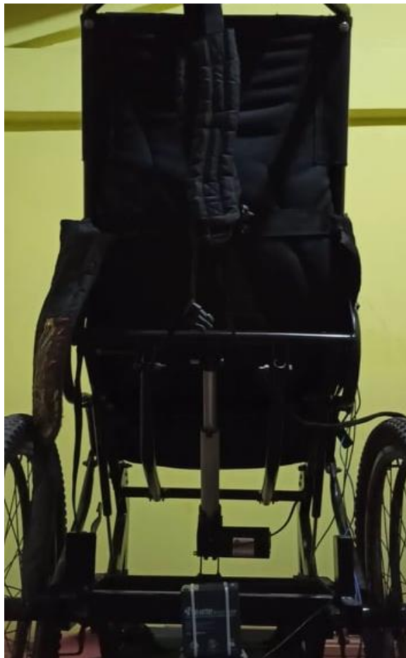
Figura 42: Sistema de elevación terminado y conectado.
