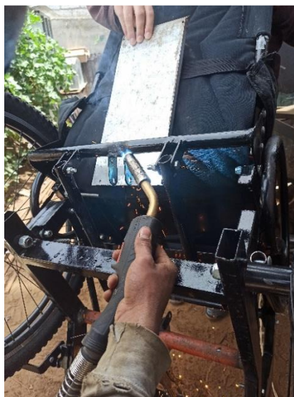
Figura 33: Soldado del eje secundario y los soportes del actuador.
