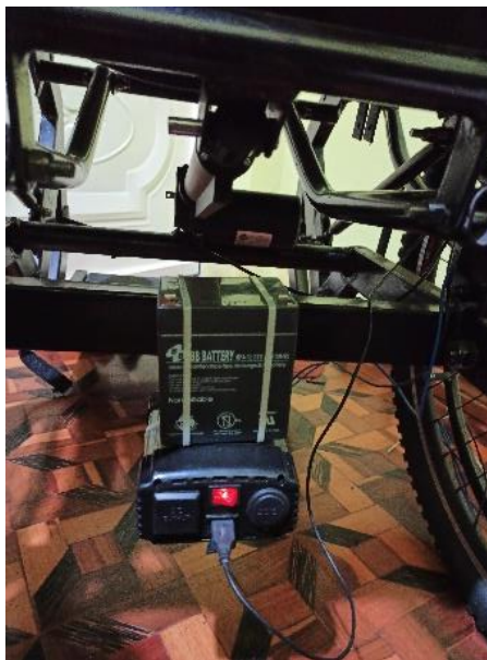
Figura 38: Colocación del inversor y batería, parte inferior de la silla.
