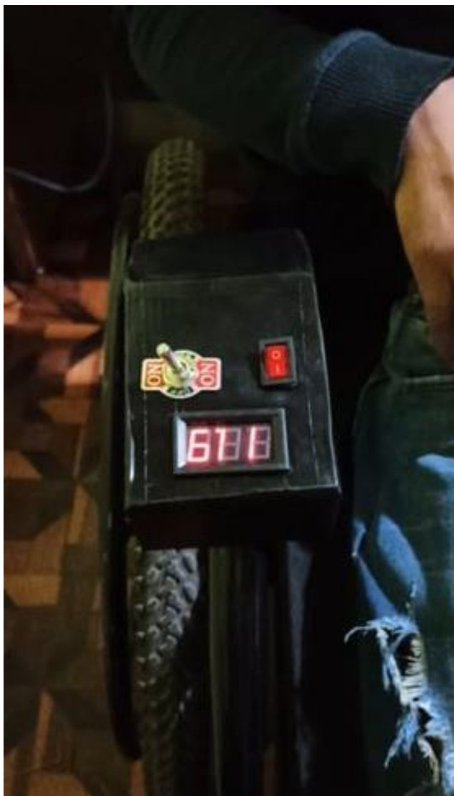
Figura 63: Control encendido - movimiento descendente del actuador.
