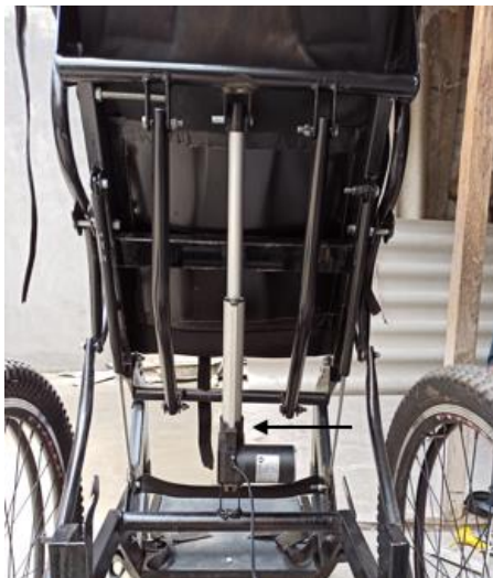
Figura 37: posicionamiento del actuador lineal, parte trasera del bipidedastador.
