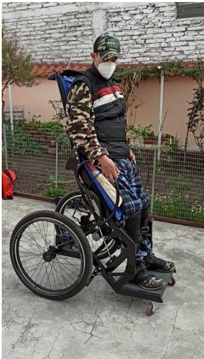
Figura 62: Control encendido - movimiento ascendente del actuador- vista frontal.
