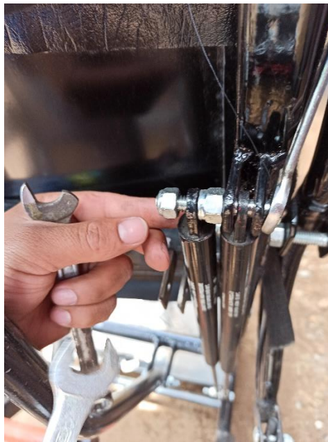
Figura 35: Posicionamiento de los amortiguadores hidráulicos.
