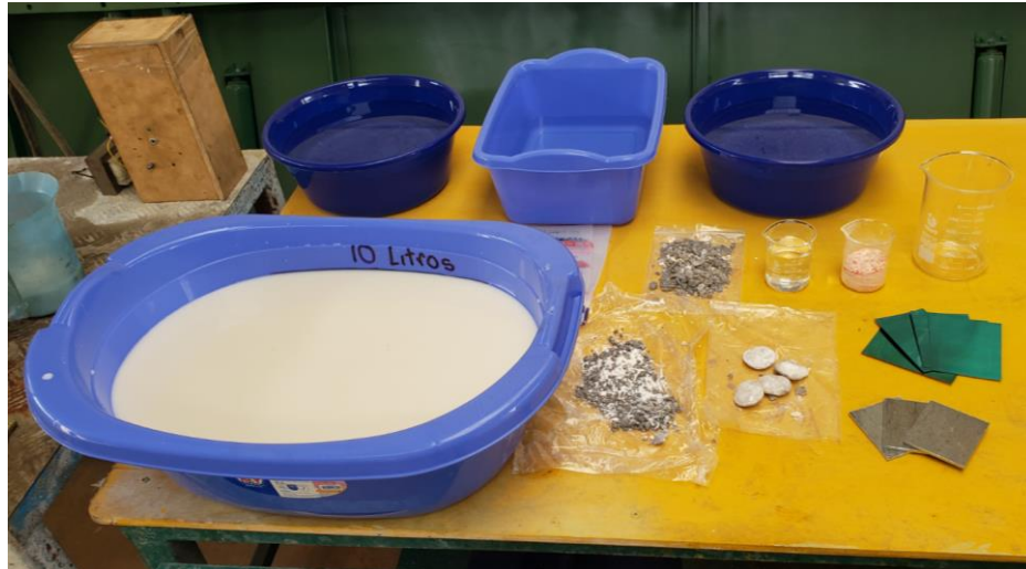
Figura 26 Cuba electrolítica de 10lt con electrolito [Autor].
