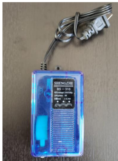
Figura 29 Bomba de aire para agitación del electrolito [Autor].
