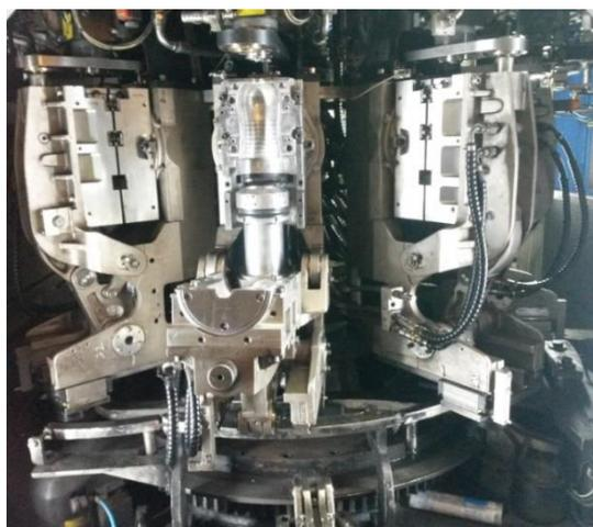
**Figura 1-23 Disposición de moldes en una sopladora rotativa [20].**
