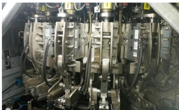
**Figura 1-16 Rueda de soplado de 16 bastidores [17].**
