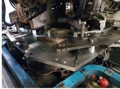
**Figura 1-17 Levas de apertura y cierre de prensa [17].**
