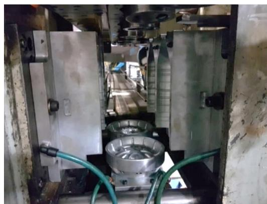
**Figura 1-25 Disposición de moldes en una sopladora lineal [20].**
