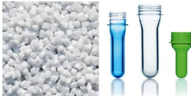
**Figura 1-11 Pellets y Preformas [14].**
