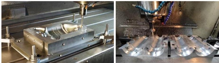
**Figura 1-4 Mecanizado CNC de moldes de soplado [11].**
