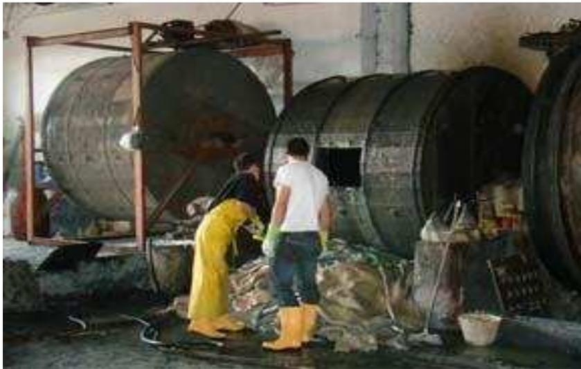
**Ilustración 29. Bombos para operaciones de Post-curtición.**
