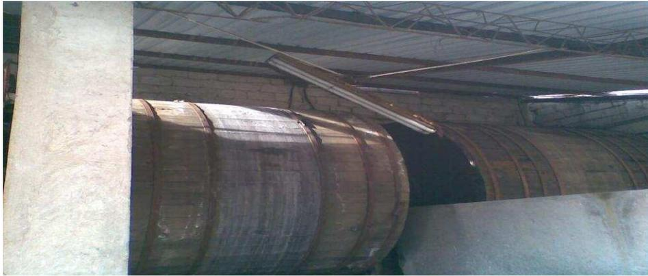
**Ilustración 36. Bombos para las operaciones de recurtición, tintura y engrase.**
