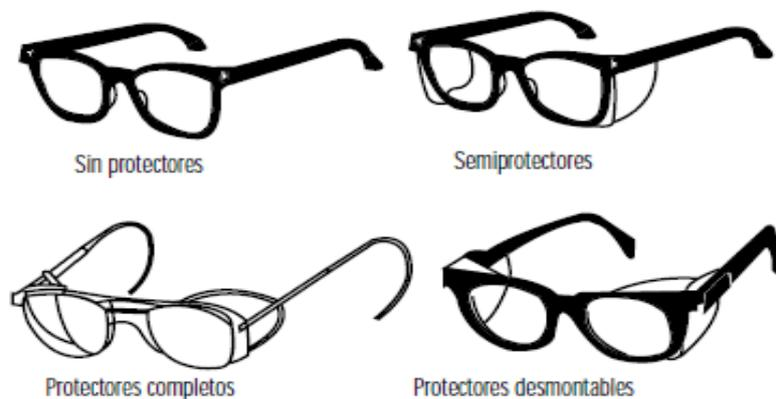
**Ilustración 51. Tipos de protección ocular**
