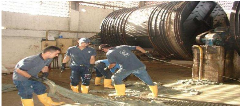
**Ilustración 25. Bombo para procesos de Remojo, Pelambre, Desencalado.**
