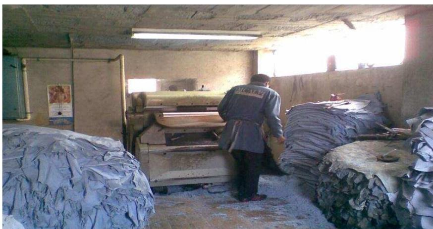
**Ilustración 83. Realización del subproceso de Rebajado.**
