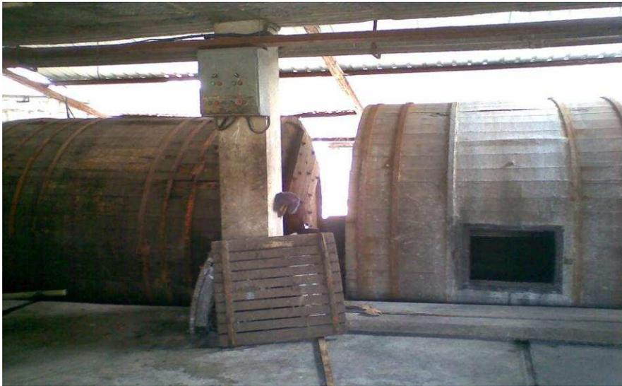
**Ilustración 34. Bombos para los procesos de Remojo, Pelambre, Desencalado, Piquel.**
