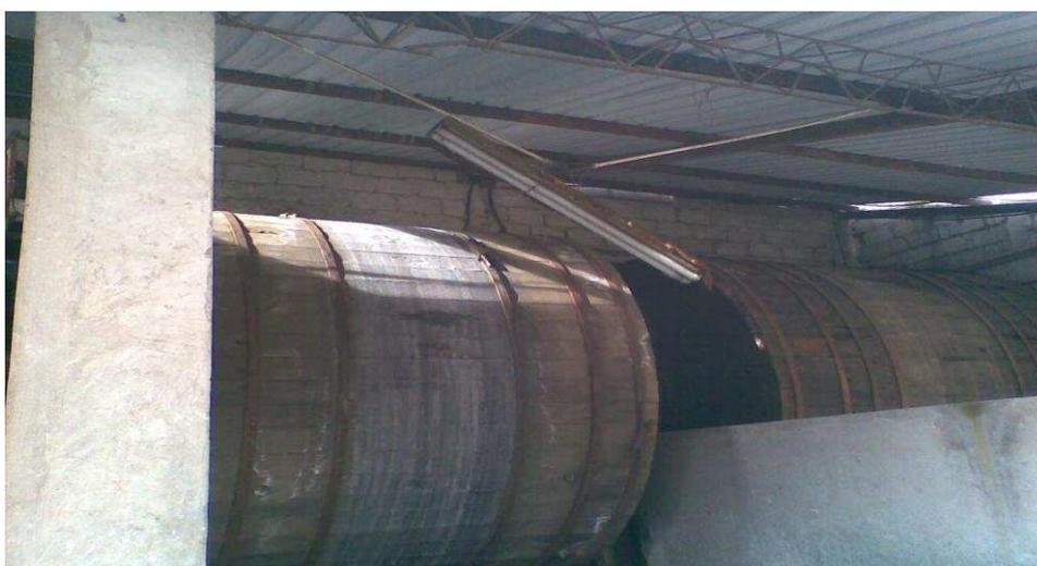
**Ilustración 81. Bombos para los subprocesos de Remojo y Pelambre.**
