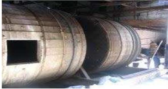
**Ilustración 27. Bombos para el proceso de Piquelado**
