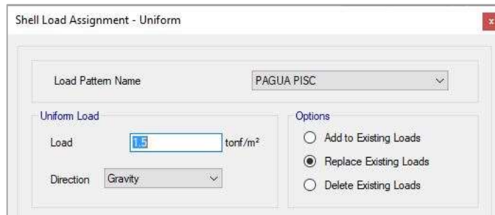
Figura 55 Asignación de carga hidrostática en el fondo de la piscina
