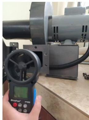
Figura 3. 28 Toma de velocidades con anemómetro. [Autor]
