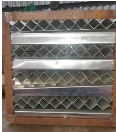
Figura 3.20 Cubo intercambiador paso del flujo de aire [Autor]
