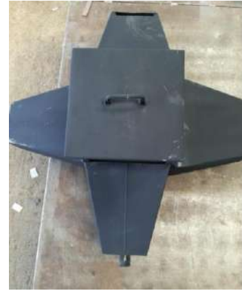
Figura 3.23 Prototipo de recuperador de calor por placas [Autor]
