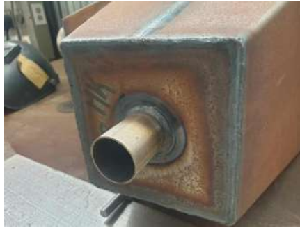
Figura 3.17 Construcción de las tapas de entra y salida del flujo de aire [Autor]
