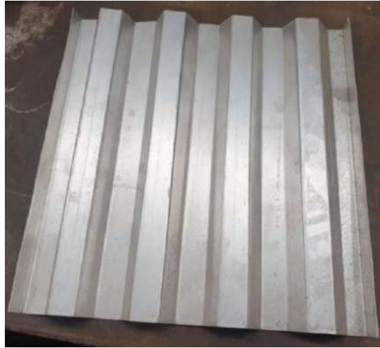
Figura 3.19 Placa de aluminio para el flujo del escape [Autor]
