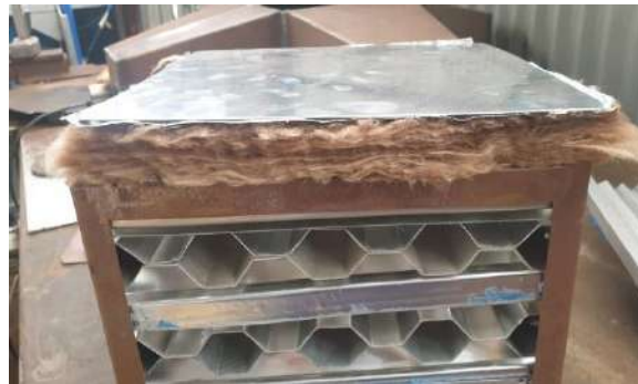
Figura 3.22 Colocación del aislante en la parte superior del cubo intercambiador [Autor]
