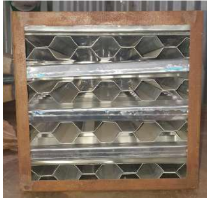
Figura 3.21 Cubo intercambiador paso del flujo del escape [Autor]
