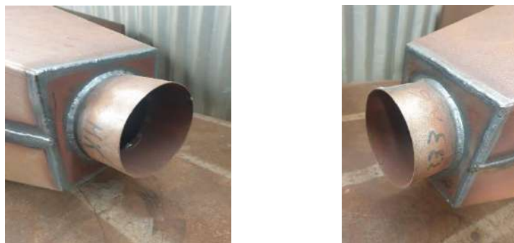
Figura 3.16 Construcción de las tapas de entra y salida del escape [Autor]
