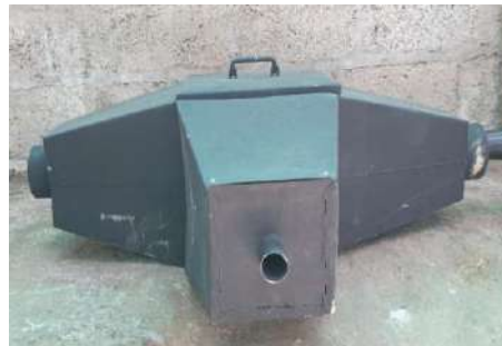
Figura 3.26 Paso del aire(izquierda) y gases de escape(derecha) [Autor]
