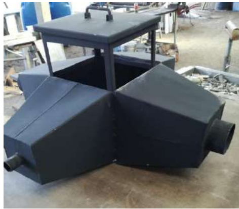
Figura 3.23 Prototipo de recuperador de calor por placas [Autor]
