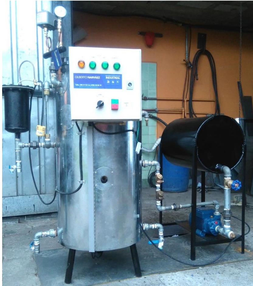
Figura 50. Caldera Generadora de vapor de 2BHP de potencia serie GN.1001 – LTJ
