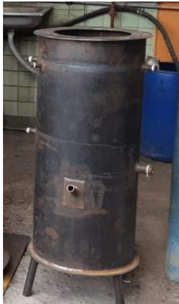
Figura 32. Estructura de caldera generadora de vapor GN.1001 - LTJ
