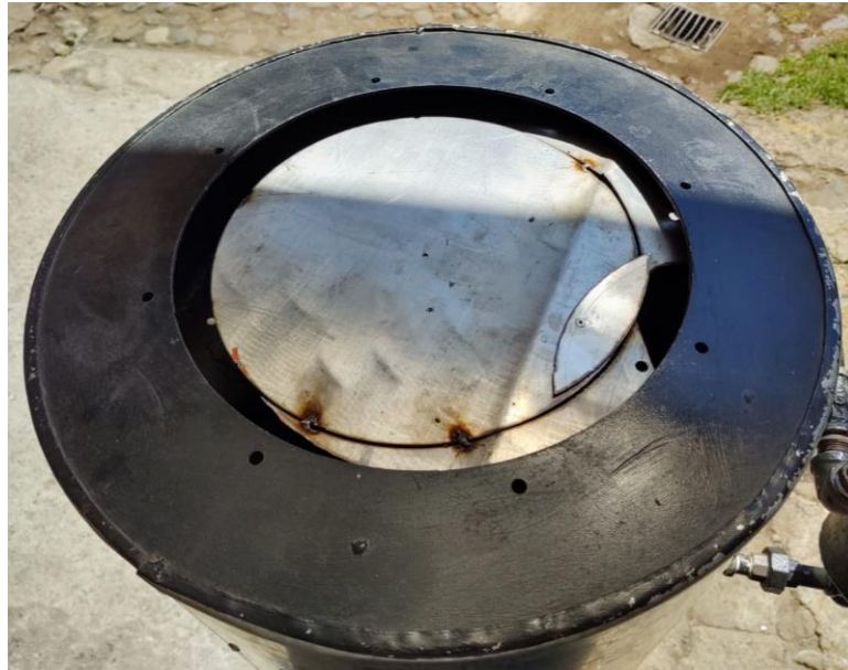
Figura 23. Rodela fija de salida de humos
