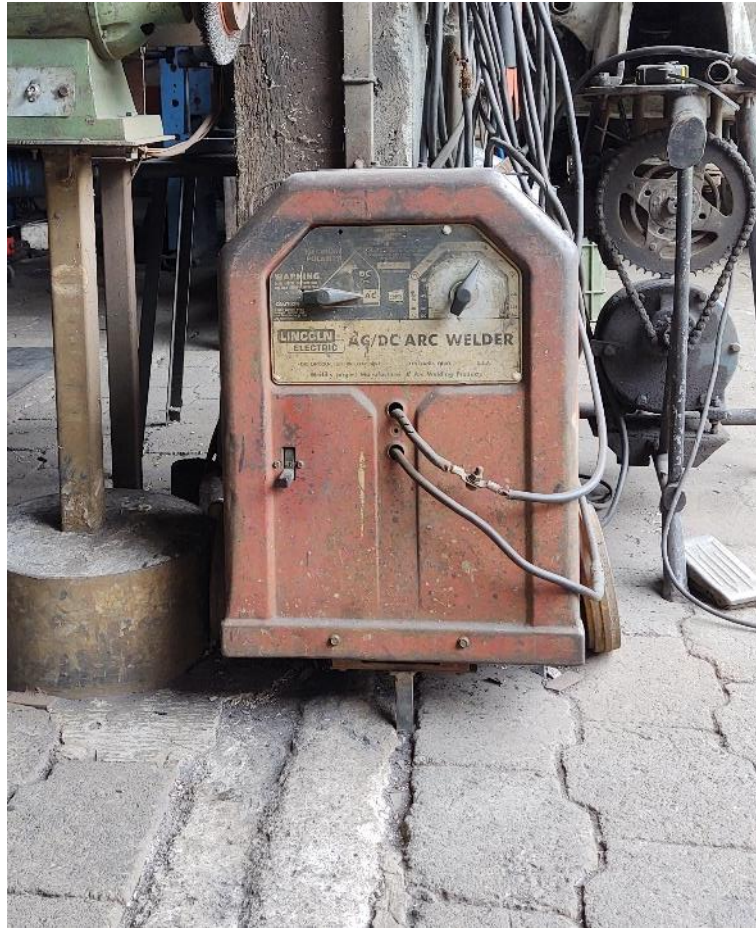
Figura 75. Ubicación fija para soldadora SMAW (proceso mejorado)
