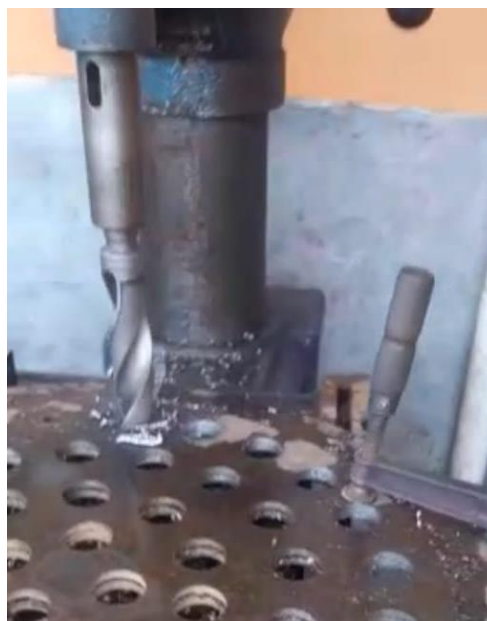
Figura 16. Perforación de espejos
