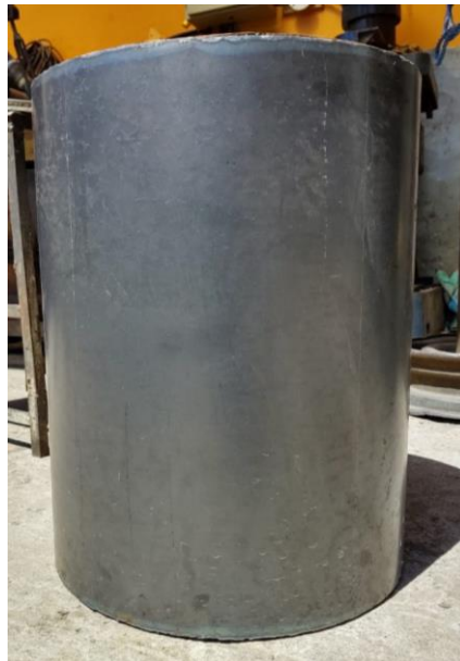
Figura 14. Cámara de fuego de caldera GN.1001 - LTJ
