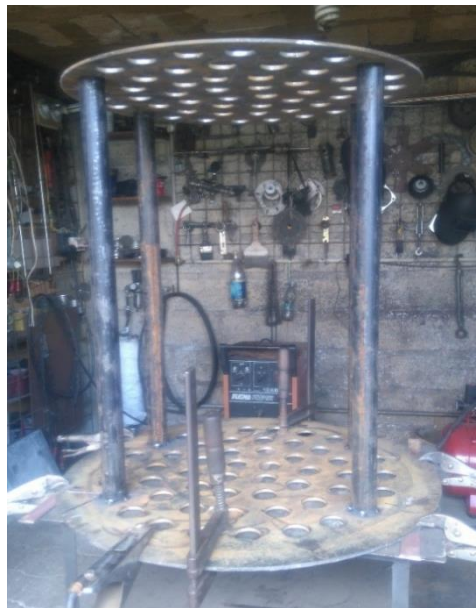
Figura 18. Ensamble espejos y tubos
