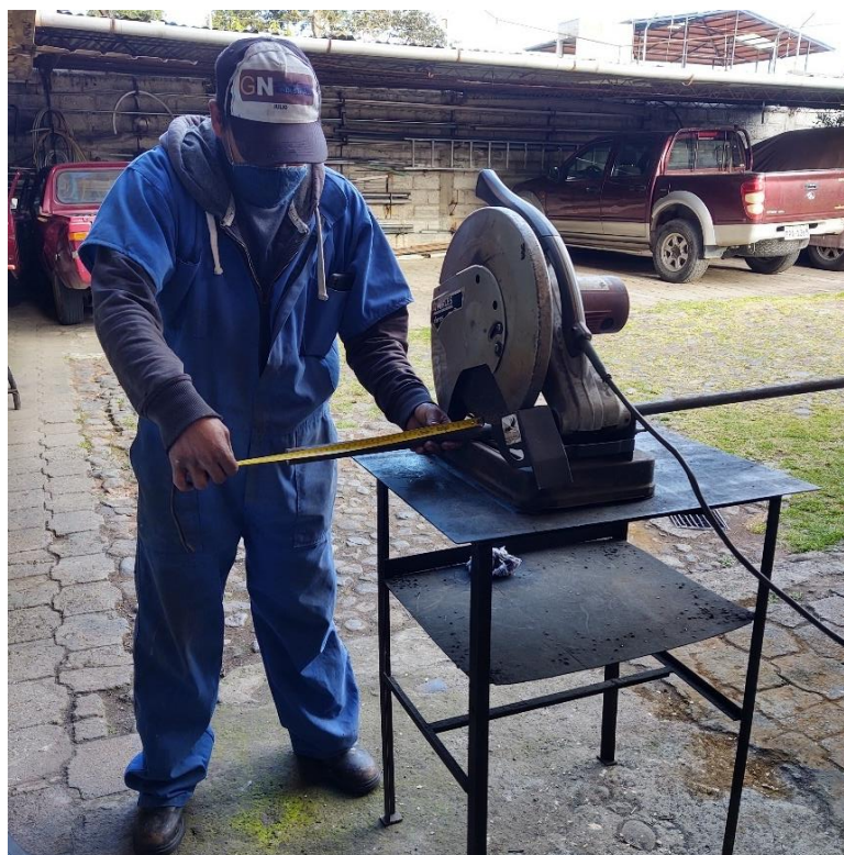
Figura 79. Corte de tubos para haz tubular (proceso actual)
