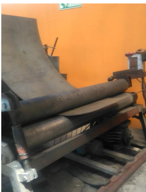
Figura 20. Rolado de plancha de acero A36, 4mm de espesor
