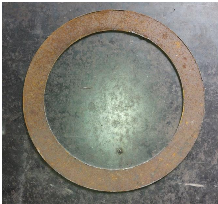
Figura 87. Rodela espaciadora para ensamble tubos - espejos (proceso mejorado)
