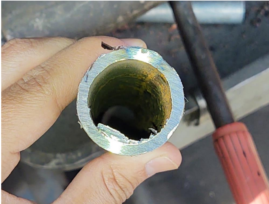
Figura 82. Tubo antes de desbarbado (proceso actual)
