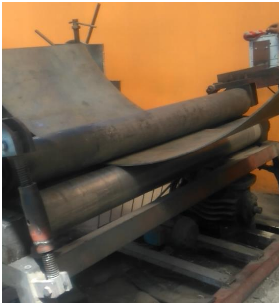
Figura 12. Rolado de plancha de acero A36 de 4mm de espesor
