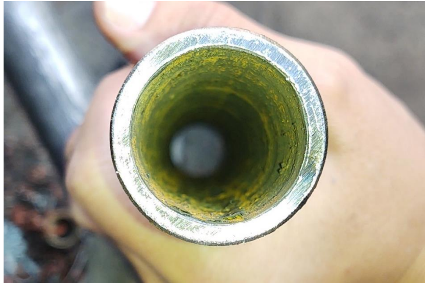
Figura 85. Tubo sometido a 30 segundos de desbarbado (proceso mejorado)
