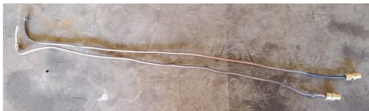
Figura 44. Cañerías por moldear necesarias para transporte de GLP
