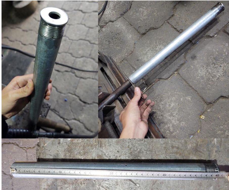
Figura 80. Molde para corte de tubos (proceso mejorado)
