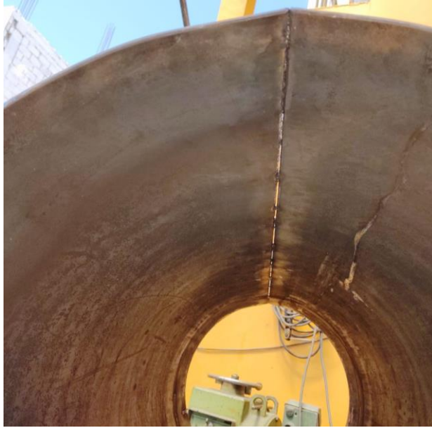
Figura 13. Cilindro de cámara de fuego asegurada con hilos cortos de suelda
