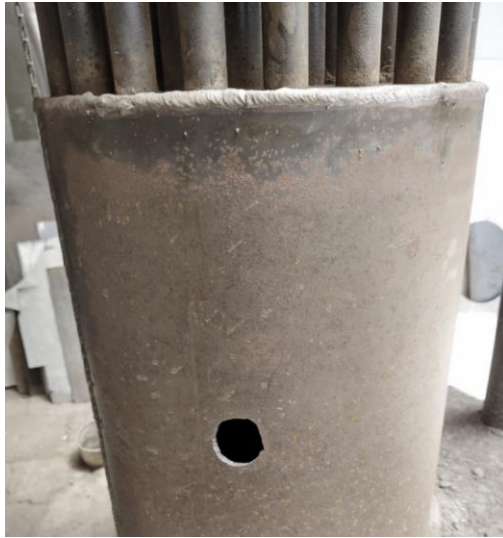
Figura 31. Agujero realizado en cámara de fuego para colocación de visor de llama
