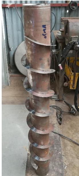
Figura 26.- Ducto con su espiral [Autor]
