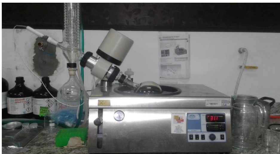
Imagen 4. Rotavapor, evaporación del solvente
