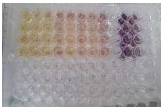
Figura 5. Muestras del extracto rico en licopenos sometidas a determinación de actividad antioxidante con DPPH.
