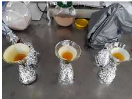
Figura 3. Filtración de las muestras para obtener el extracto rico en licopenos.
