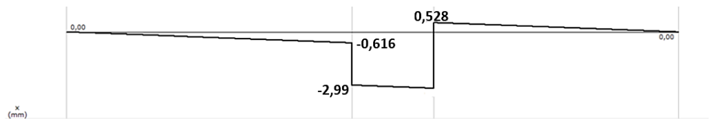
Figura 42. Diagrama de momentos flectores del eje de la cuarta etapa.
