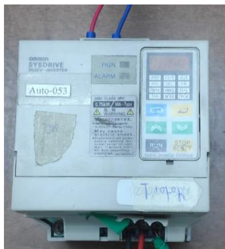
Figura 55. Variador de frecuencia.
