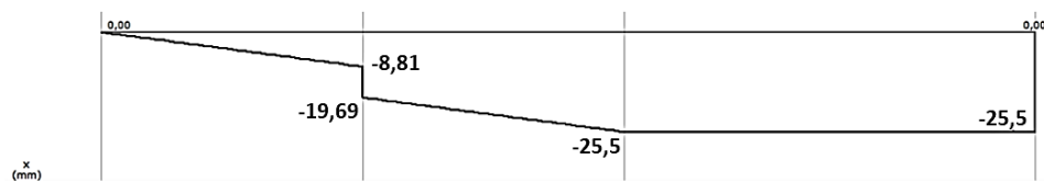
Figura 36. Diagrama de momentos flectores del eje de la segunda etapa.
