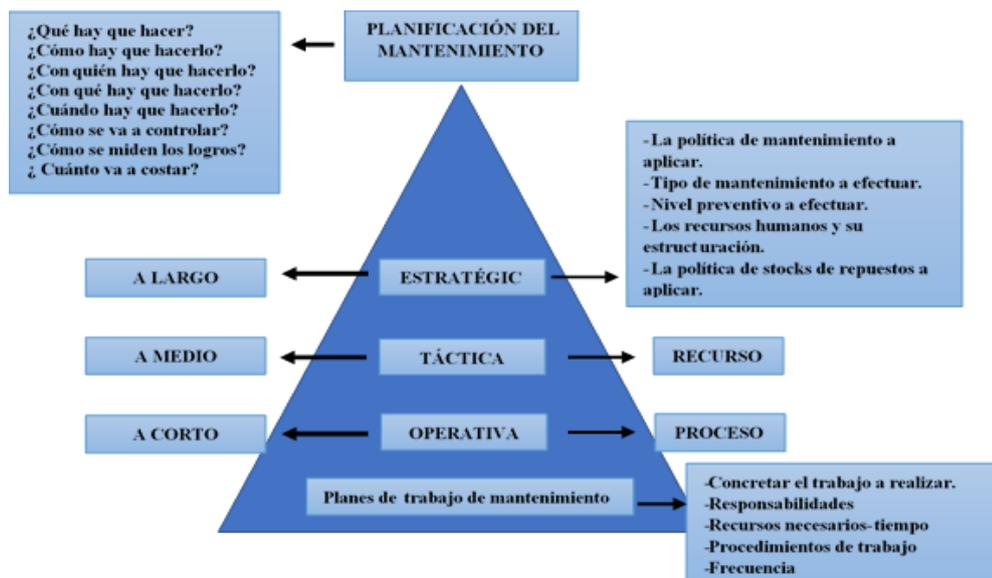
Figura 1.3: Planificación del mantenimiento [13]
