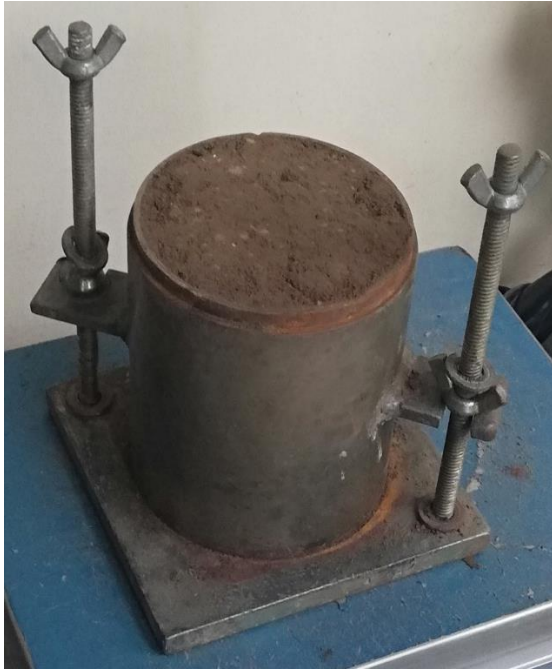
Anexo A-19. Máquina para ensayo de CBR
