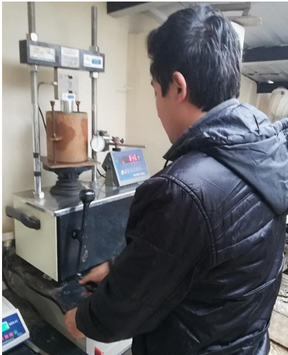
Anexo A-19. Máquina para ensayo de CBR
