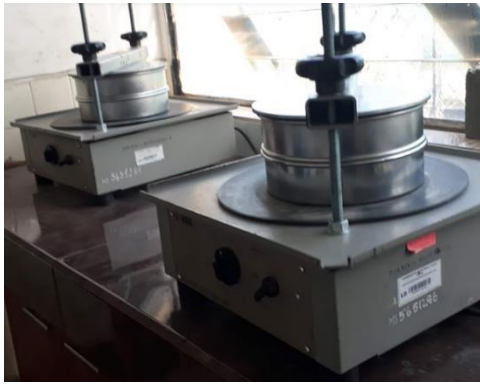
Figura 70. Tamizado material molido.
