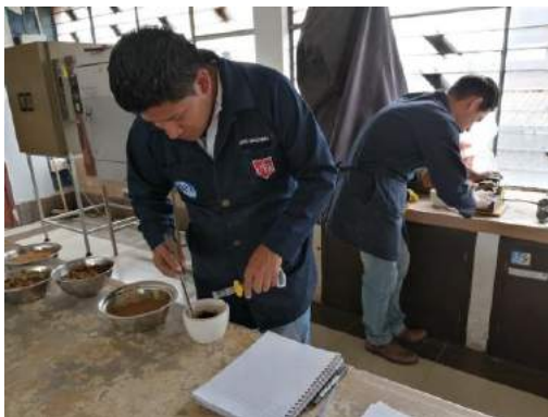
Fotografía 10: Ensayo de límites de Atterberg
