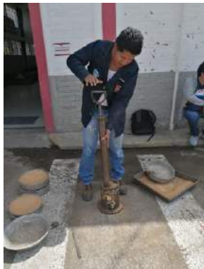
Fotografía 22: Ensayo Proctor modificado
