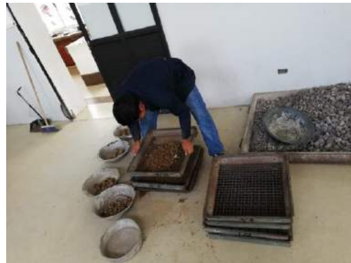
Fotografía 15: Ensayo de granulometría de Subbase
