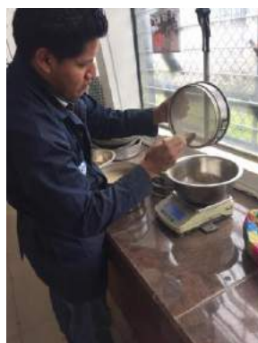
Fotografía 16: Ensayo de Granulometría de Subrasante
