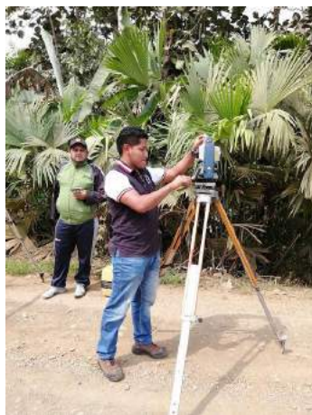
Fotografía 4: Georreferenciando la estación total
