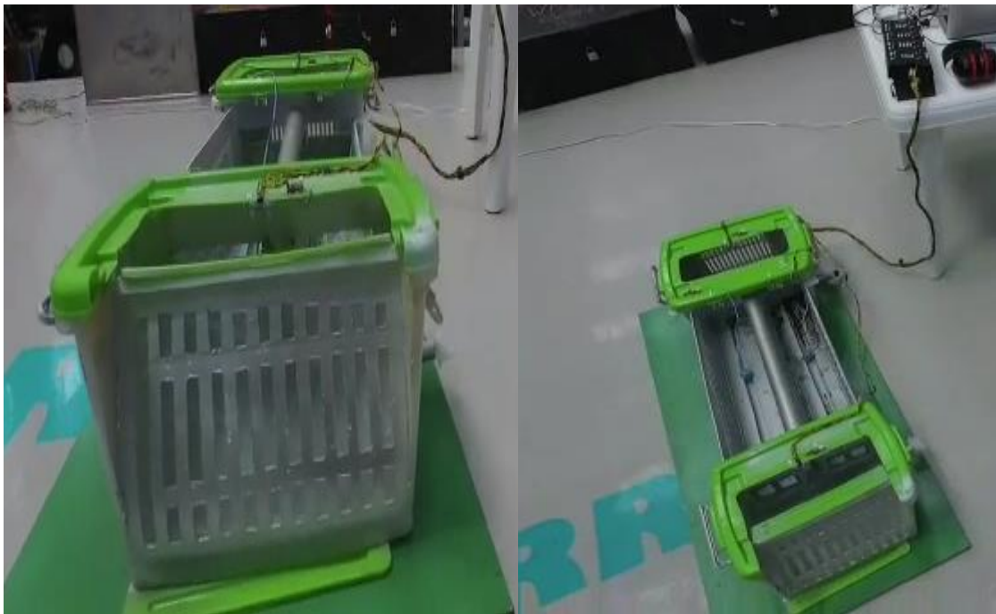
Figura 126. Prototipo del sistema de monitoreo y control de compuertas de purga en la casa de máquinas de la central hidroeléctrica Río Verde Chico.
