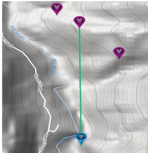
Figura 58. Enlace desde sector de captación de agua de central hidroeléctrica, hasta punto de repetición.
