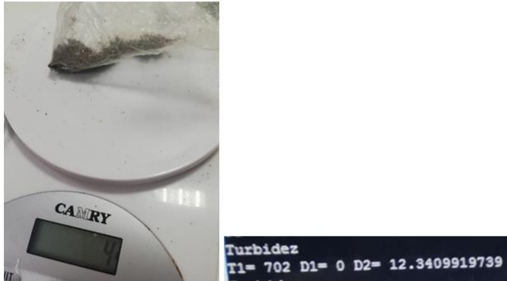
Figura 115. Medición de turbidez con una concentración de 4 gr/lit
