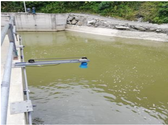
Figura 15. Sensor de medición de nivel de agua del embalse
