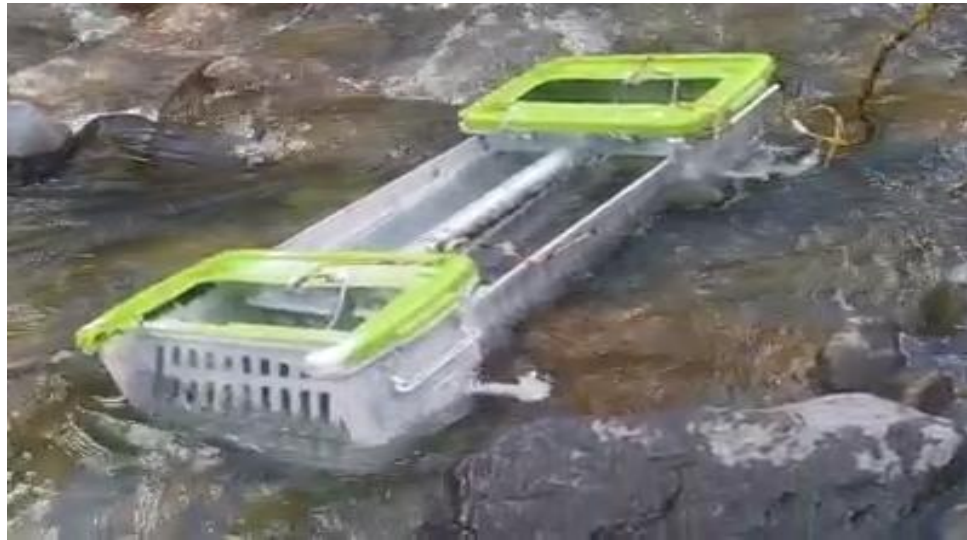
Figura 100. Prototipo de monitoreo y control del sistema de captación de agua, en el Río Verde Chico.
