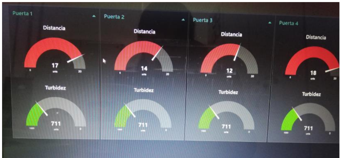
Figura 120. Tanques 1, 2, 3, 4 con buen nivel de agua y alta turbidez
