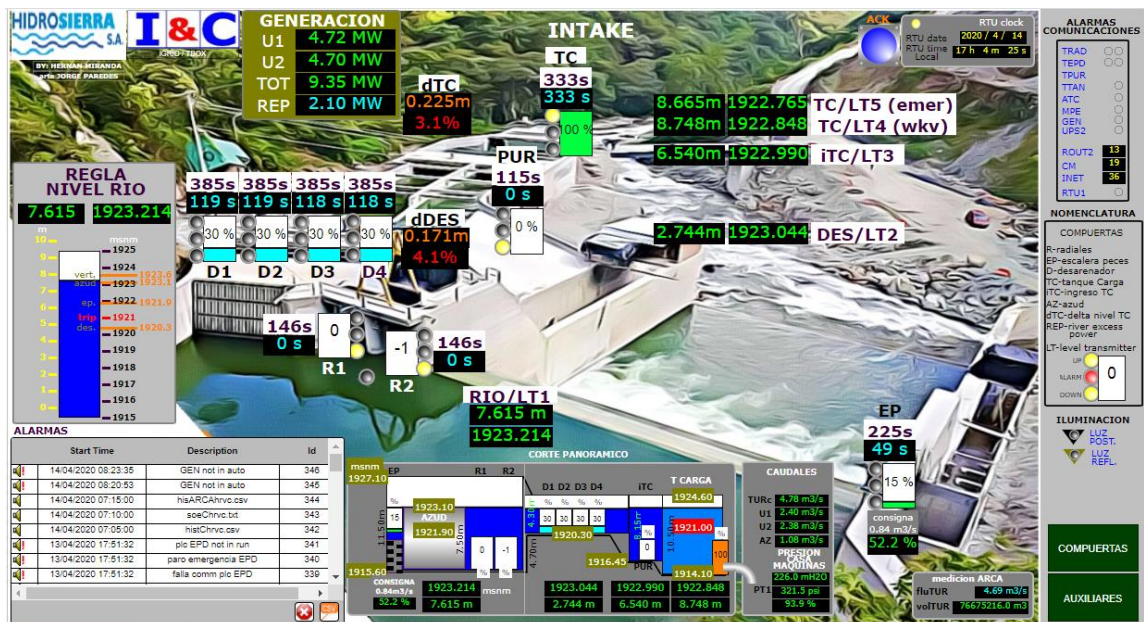
Figura 43. HMI del sistema de captación de agua.
