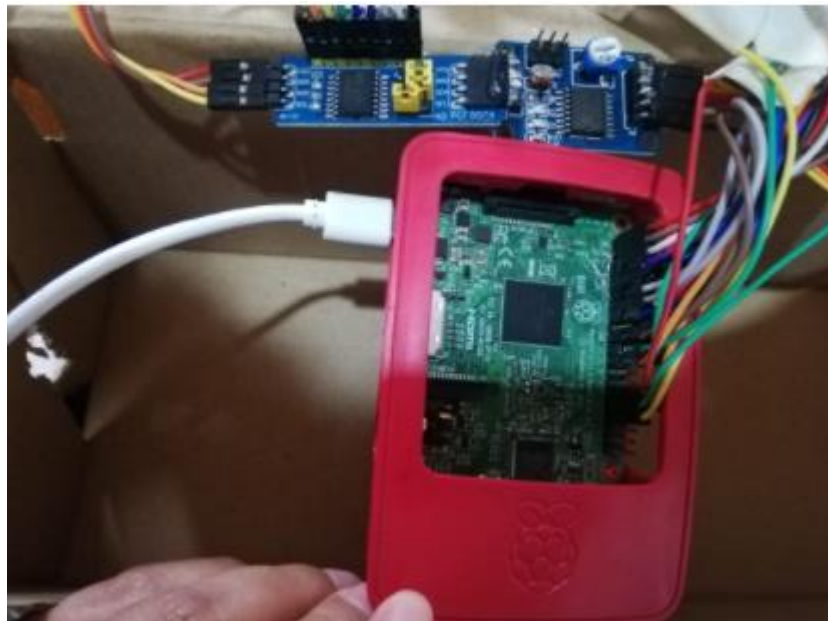
Figura 107. Conexiones de Raspberry PI con módulos PCF-8574 y PCF-8591.
