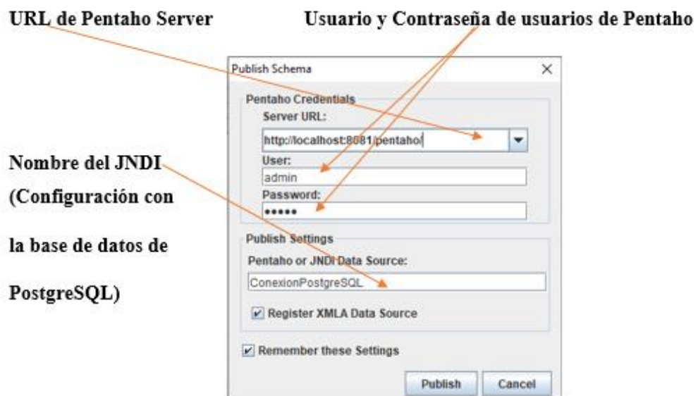
Fig. 135 Configuración para la publicación de los cubos de datos en la herramienta Pentaho Server.
